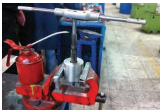
شکل ۲۵- تنظیم و هدایت برقو به داخل قطعه کار
