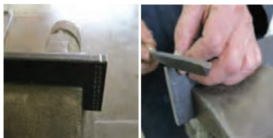
شکل ۲۹- استفاده از سوهان سه گوش
