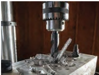
شکل ۳۱- عملیات سوراخ کاری قبل از برقکاری
