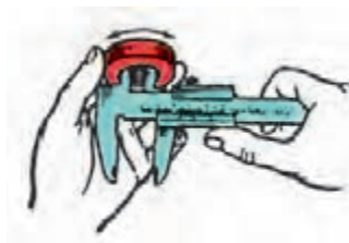
شکل ۲۰- کاربرد کولیس ورنیه (اندازه‌گیری قطر داخلی و اندازه‌گیری شیار)
