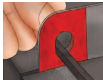
شکل ۴۱- تبدیل سوراخ گرد به چهارگوش
