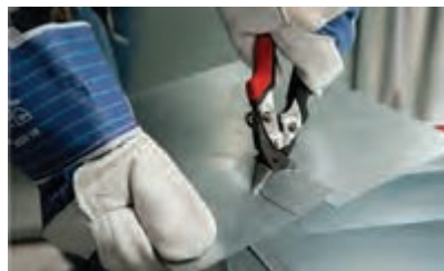
شکل ۱۱- نحوه اعمال فشار در برش کاری با قیچی دستی
