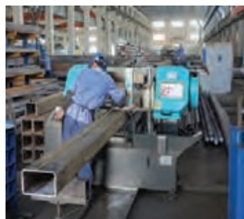
شکل ۵- برش پروفیل های خام در کارخانه
