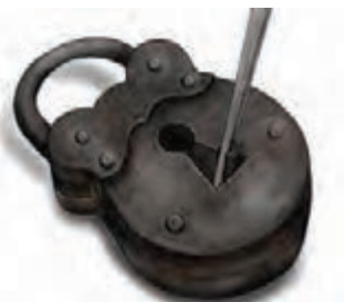
شکل ۴۲- رفع ایراد قفل با سوهان کاری
