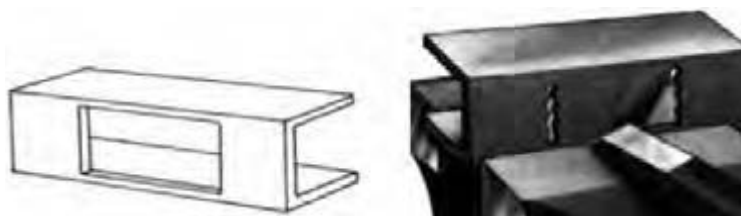
شکل ۲۴- درآوردن داخل قطعات توسط قلم
