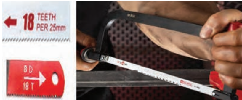
شکل ۲۵- طریقه صحیح بستن تیغه و گرفتن کمان اره
