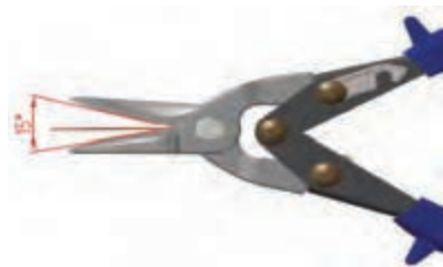
شکل ۱۲- زاویه مورد نیاز برای برش کاری با قیچی دستی
