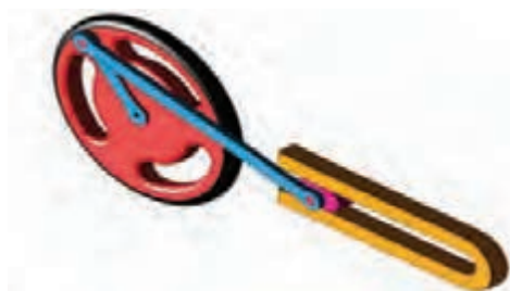
شکل ۳۷- مکانیزم انتقال حرکت در اره لنگ
