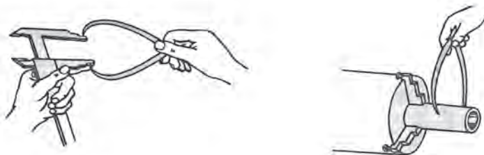
شکل ۳۰- اندازه‌برداری از قطعه کار و خواندن اندازه به کمک کولیس
