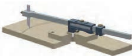
شکل ۵۲- کاربرد پرگار موازی‌کش و ورنیه‌دار
