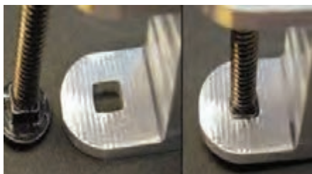
شکل ۴۷- تبدیل سوراخ گرد به چهار گوش
