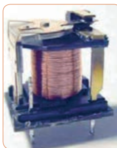
شکل ۳۴-۶ ساختمان داخلی دو نوع رله
