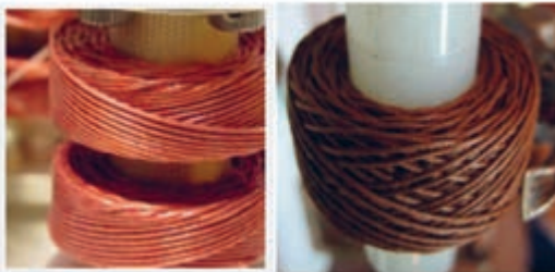
شکل ۶-۲- سیم پیچ چندلایه با روش لانه زنبوری
