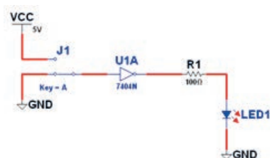
شکل ۵۹-۶ مدار گیت منطقی NOT
