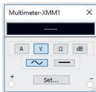
شکل ۳۷-۴ تنظیم مولتی‌متر برای اندازه‌گیری ولتاژ AC
