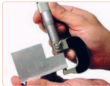
شکل ۱۶- ۲- چگونگی در دست گرفتن میکرومتر
