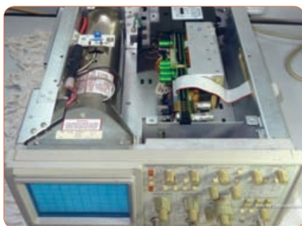
شکل ۵۲-۴- ساختمان داخلی یک نوع اسیلوسکوپ
