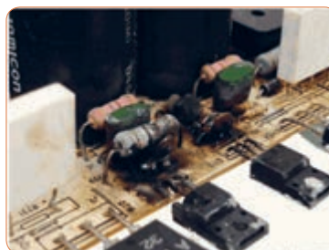
شکل ۲۴-۵ - آسیب قطعات در یک برد
