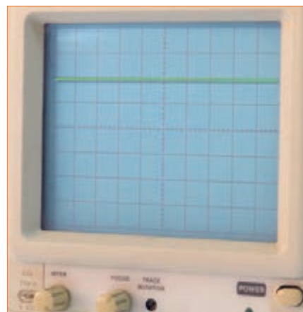
شکل ۷۴-۴- موج DC روی صفحه نمایش
