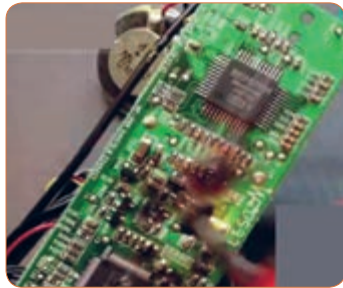
شکل ۵-۵ - قطعاتی از برد سوخته است.
