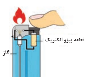
شکل ۱۲ (ج) - کاربرد پیزوالکتریک در فندک
