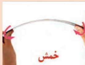
شکل ۵-۵- انواع بارگذاری روی نوار فلزی
