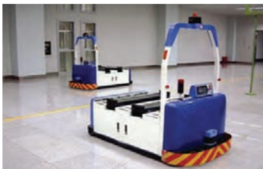
شکل ۲۸- ماشین اتوماتیک هدایت‌شونده با لیزر
