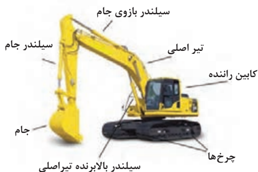
شکل ۵- قسمت‌های مختلف بیل مکانیکی
