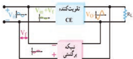
شکل ۱۰-۱۸- بلوک دیاگرام تقویت کننده با فیدبک منفی
