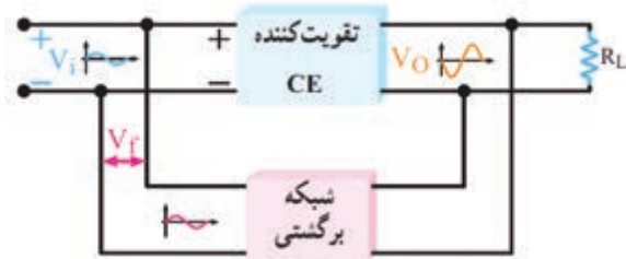
شکل ۱۰-۱۶- بلوک دیاگرام تقویت کننده با فیدبک
