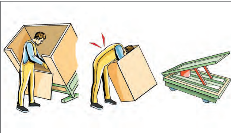
■ شکل ۳۴-۴- طراحی ارگونومیک پایه یک جعبه
