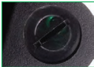
ح - رنگ سبز چشمی، نشانهٔ شارژ بودن باتری است.
