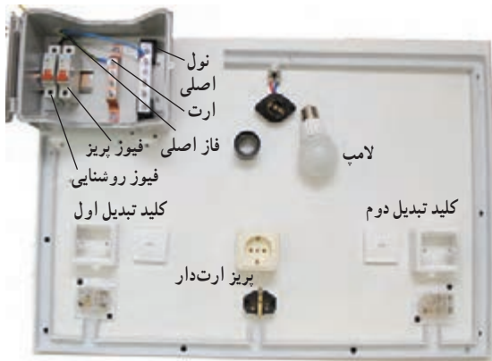
شکل ۲۰-۶- جانمایی قطعات مدار کلید تبدیل
