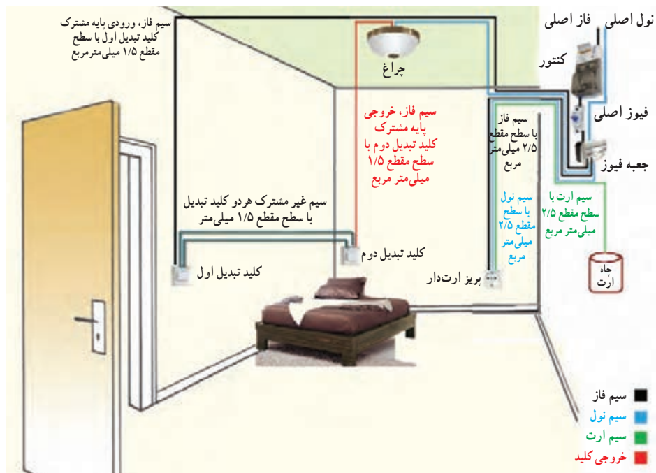
شکل ۱۸-۶ - سیم‌کشی مدار کلید تبدیل
