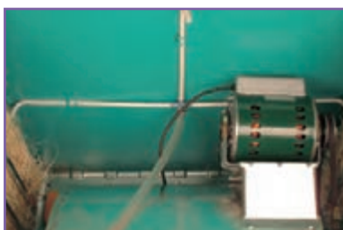
ح- آزمایش صحت مدار آب پخش‌کن
