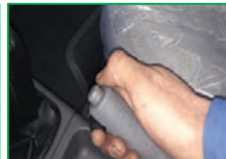
الف - خودرو را خاموش کنید و ترمز دستی را بکشید.
