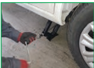
ج- خودرو را با استفاده از جک به آرامی بالا ببرید.
