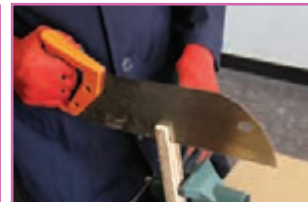
ث- اره کاری شیار بازوی چوبی
