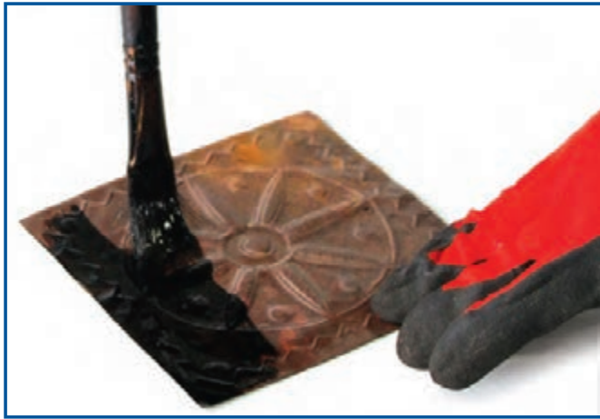
شکل ۱۰-۱۱- آغشته کردن سطح پلاک مسی به قیر
