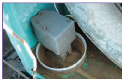
ج- بررسی و تمیز کردن پمپ آب
