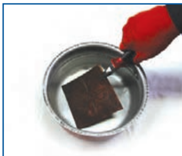
شکل ۹-۱۱- سرد کردن پلاک مسی با آب
