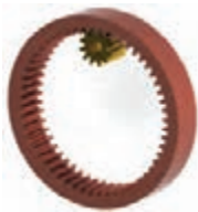
ج- ساز و کار حرکتی چرخ دنده داخلی
