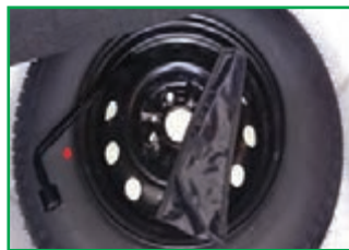
ب- آچار چرخ و جک بالا بردار خودرو را آماده کنید.
