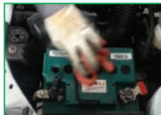
پ - در صورت کم بودن سطح مایع باتری، با پارچهٔ تمظیف سطح آن را تمیز کنید.
