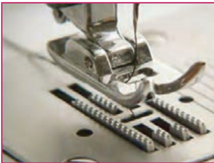
ب- ساز و کار حرکتی شانه(دندان) کار پیش بر چرخ خیاطی
