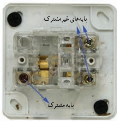
شکل ۱۹-۶- نمای داخلی یک نمونه کلید تبدیل
