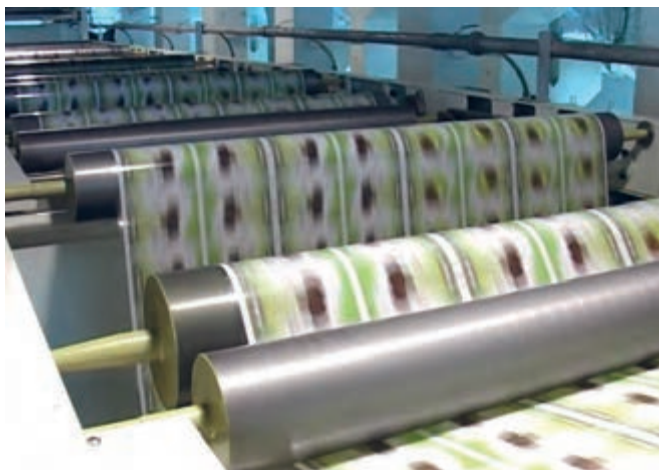
شکل ۵۴- عبور سطح چاپی از بین غلتک‌ها
