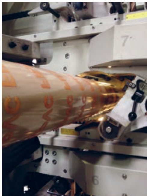
شکل ۳۵- جاگذاری سیلندر کلیشه بر روی آداپتور
