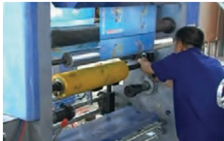
شکل ۶۴- نصب پرس رول سمت اپراتور
