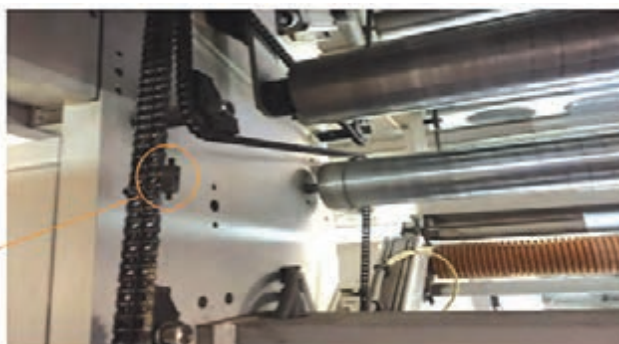
شکل ۵۶- زنجیر مخصوص عبور سطح چاپی
