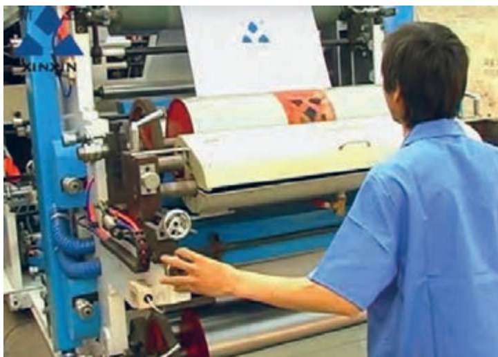
شکل ۲- تنظیم فشار پلیت و سیلندر چاپ
