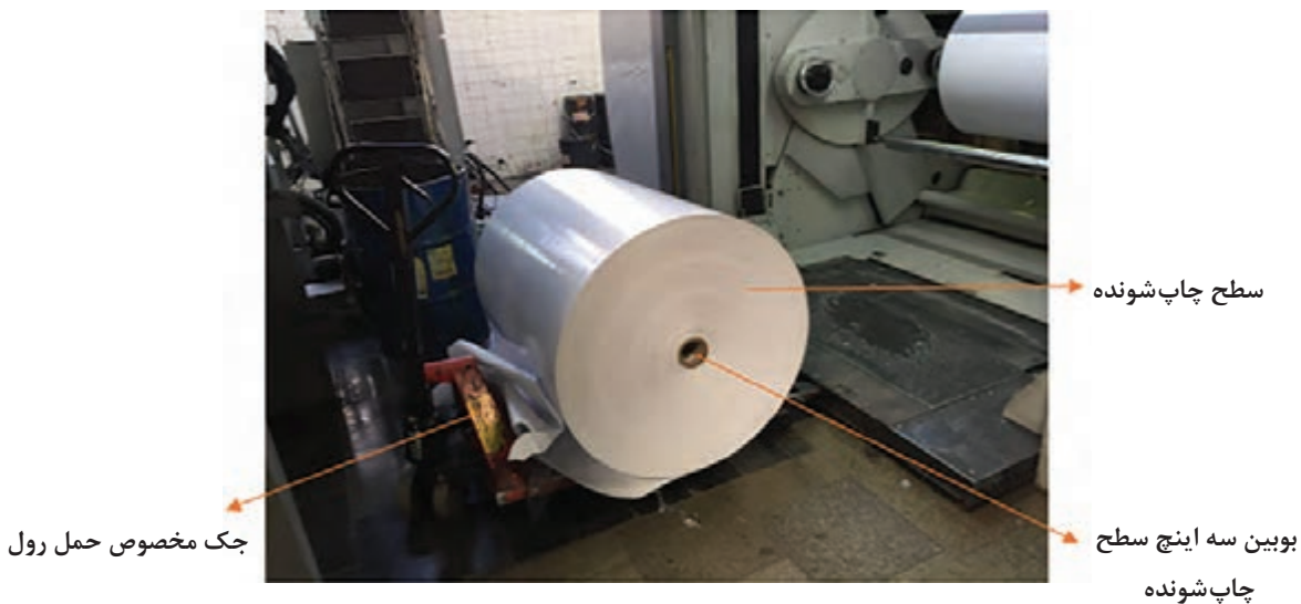
شکل ۳۳- انتقال سطح چاپ شونده به واحد تغذیه
