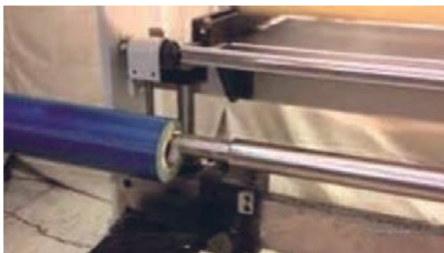
شکل ۱۴- قرار دادن آداپتور روی شفت کلیشه چسبانی
