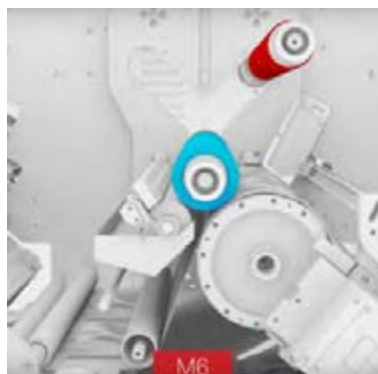
شکل ۳- سیلندر فرم غلافی (اسلیو) در دو ماشین دیجیتال فلکسو
