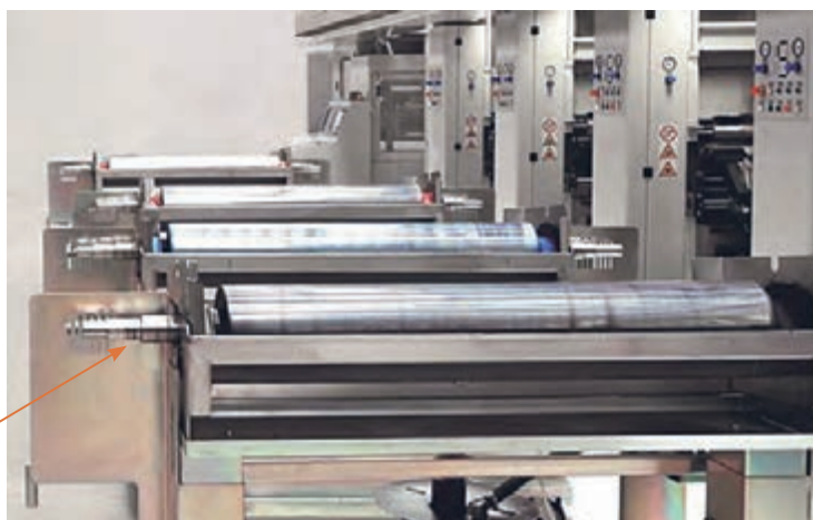
شکل ۴۴- واگن سیلندر جهت نصب در ماشین چاپ
