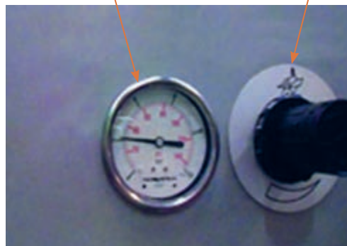
شکل ۶۶- تنظیمات فشار پرس رول طرف موتور
