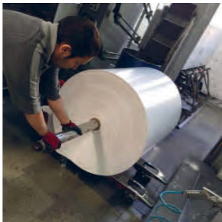
شکل ۳۴- قرار دادن شفت بادی درون بوبین دستگاه
