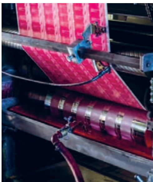
شکل ۵۲- یکنواختی مرکب در سطح چاپی
