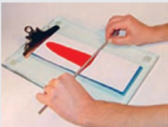
شکل ۲۹- روش کشیدن مرکب با ابزار بارکش
