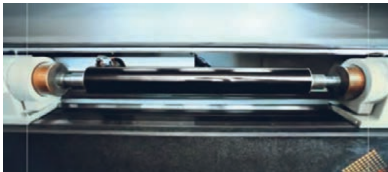
شکل ۲۷- دستگاه حکاکی لیزری سیلندر
