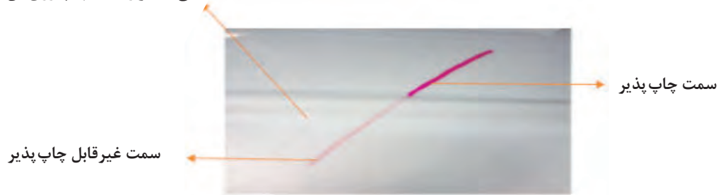
شکل ۲۲- نتیجه تست کرونا تریتمنت
