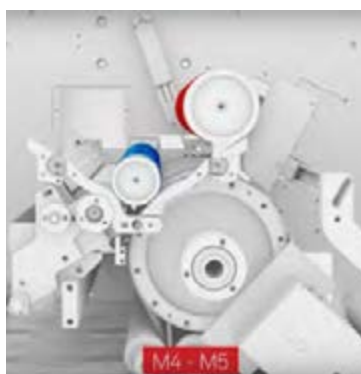
شکل ۳- سیلندر فرم غلافی (اسلیو) در دو ماشین دیجیتال فلکسو
