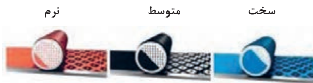
شکل ۱۱- شماتیک فشردگی ذرات فوم چسب پایه
