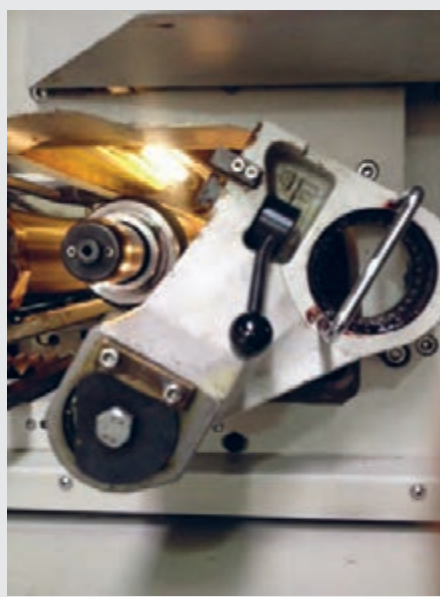
شکل ۳۶ - باز کردن و بستن قفل یک دک
