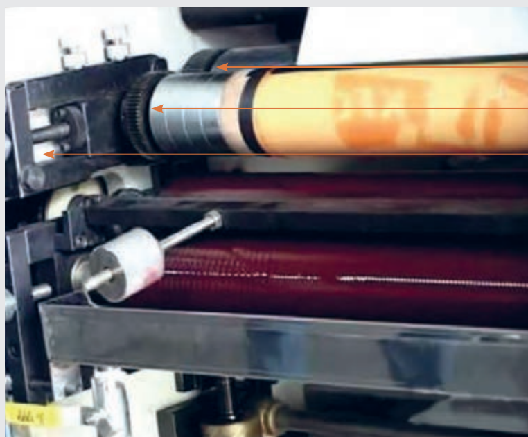
شکل ۳۰- چرخ دنده‌های دستگاه چاپ سیلندر مرکزی
