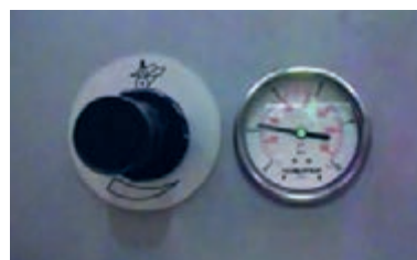
شکل ۵۴- دستگیره تنظیم فشار و گیج آن
