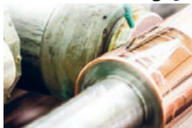
شکل ۲۰- پولیش کاری سیلندر
