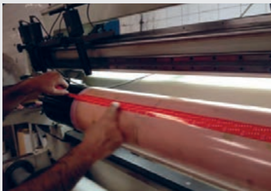
شکل ۲۸- نحوه چسباندن چسب لبه کلیشه
