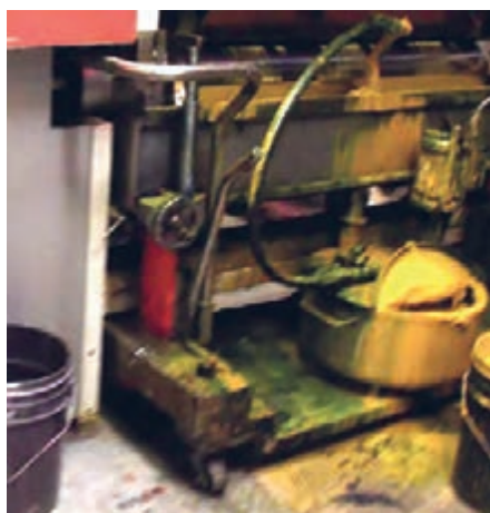
شکل ۴۸- سر ریز شدن مرکب
