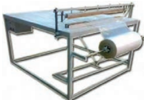
شکل ۱۲-۲۰. دستگاه بسته‌بندی اولیه حبوبات
