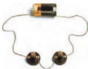
شکل ۵-۳- مدار واقعی دو لامپ به صورت سری
