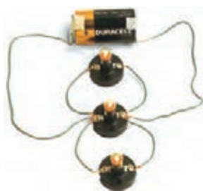
شکل ۵-۵۳ اتصال سه لامپ به صورت موازی
