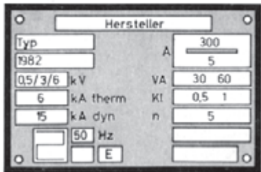
شکل ۵-۶۷- تابلوی مشخصات ترانسفورماتور جریان
