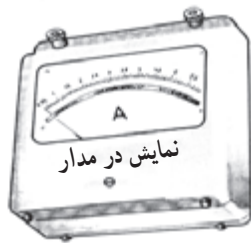
شکل ۲۹-۵ شکل ظاهری آمپر متر
