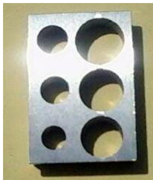
شکل ۲۱-۴- قطعه کار پس از عملیات برقوکاری
