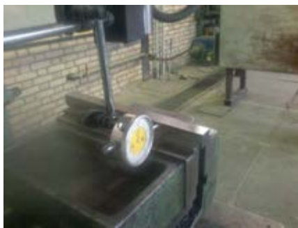
شکل ۱۹-۴- تنظیم و بستن گیره روی میز دریل
