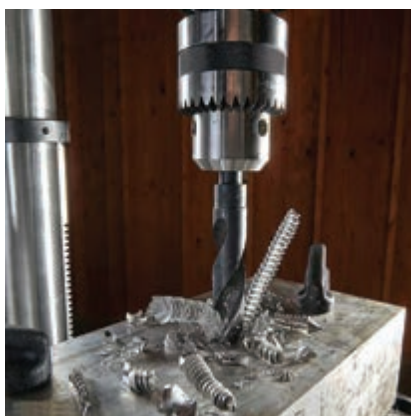
شکل ۳۰-۳- عملیات سوراخ کاری قبل از برقوکاری
