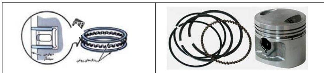
شکل ۱۶-۵- کاربرد خار فنری
