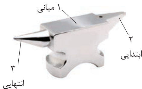
شکل ۲۸-۱- خم کاری روی سندان
