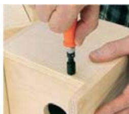
شکل ۲۷-۴ - خزینه کاری دستی
