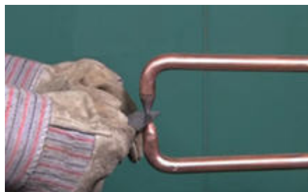
اعمال فشار الکتروودها بر روی قطعه کار
