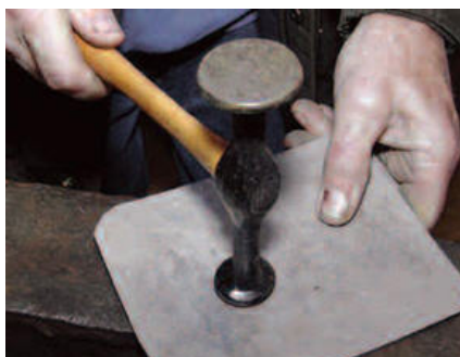
شکل ۲۸-۱- خم کاری روی سندان
