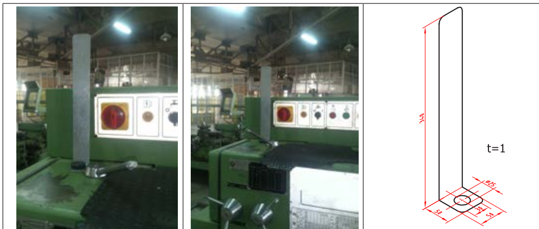
شکل ۲۱- ۱- چگونگی بستن پایه نقشه
