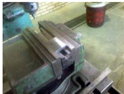
شکل ۱۸-۴- بستن قطعه کار
