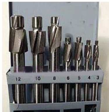
شکل ۴-۲۹- انواع مت‌ه خزینه‌ای استوانه‌ای دنباله‌دار
