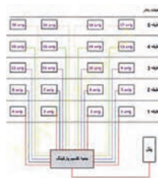
الف- نقشه سیم‌کشی درب‌بازکن
