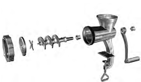
شکل ۶۷- تصویر سه بعدی انفجاری چرخ‌گوشت دستی
