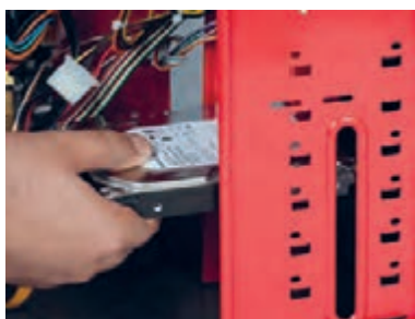
شکل ۴۸- محل نصب دیسک سخت
