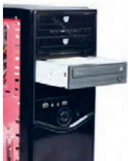
شکل ۵۰- قراردادن دیسک‌گردان نوری در کیس
