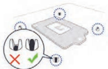
شکل ۳۸ - پایه‌های سیستم خنک‌کننده در پشت برد اصلی
