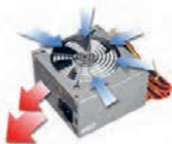
شکل ۲۳- جهت تهویه هوا در منبع تغذیه
