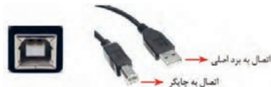
شکل ۱۹- درگاه اتصال USB به چاپگر و کانکتورهای دوسر کابل چاپگر برای اتصال
