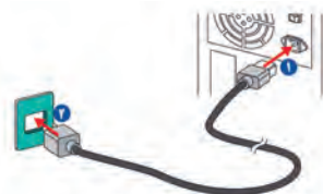
شکل ۵۲- الف) اتصال کابل برق
