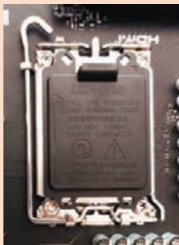
شکل ۱۱- پد محافظ سوکت پردازنده
