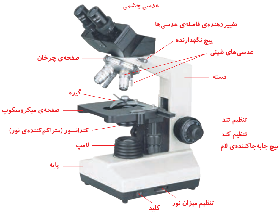
میکروسکوپ و اجزای آن
