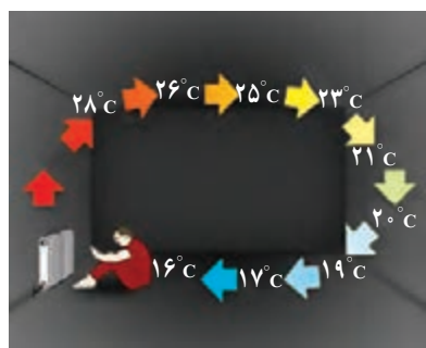
شکل ۴-۲۸ گرم شدن هوای اتاق به روش همرفت
