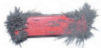
شکل ۳-۳ در آهنربا، دو ناحیه وجود دارد که خاصیت مغناطیسی در آنجا بسیار بیشتر از قسمت‌های دیگر است.
