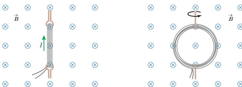
شکل ۳-۴ با چرخاندن پیچه درون میدان مغناطیسی \vec{B} ، زاویه بین میدان مغناطیسی و سطح پیچه تغییر می‌کند. این تغییر زاویه سبب القای جریان در پیچه می‌شود.
