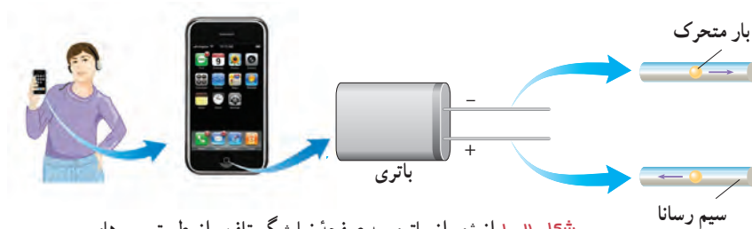
شکل ۲-۱ انرژی از باتری به صفحه نمایشگر تلفن، از طریق سیم‌های رسانایی که در آنها بارهای الکتریکی در جریان‌اند، منتقل می‌شود.
