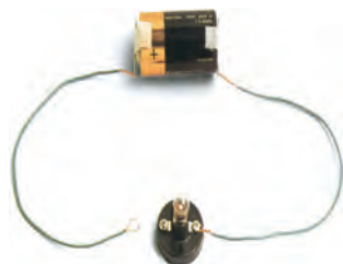
شکل ۵-۸ قطع شدگی در مدار
