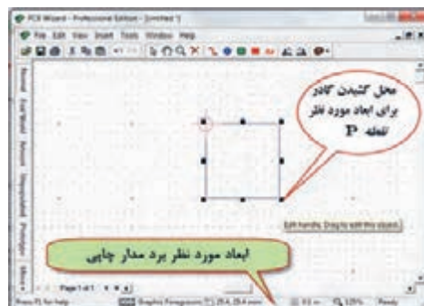
شکل ۳۸-۶- نحوه تعیین اندازه برد مدار چاپی
