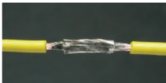
شکل ۱-۵۵- اتصال لحیم کاری کامل است.
