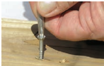
شکل ۲۹-۱- انتخاب آچار مناسب مانع خرابی گل پیچ می شود
