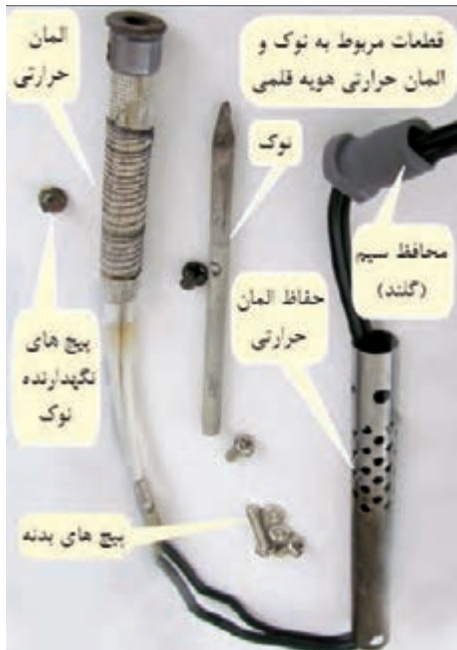
شکل ۹۵-۱ - مراقبت از اجزاء داخلی هویه قلمی
