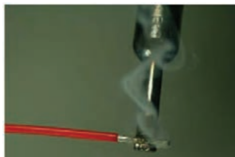
تماس نوک هویه با سیم مسی و شروع به گرم شدن
