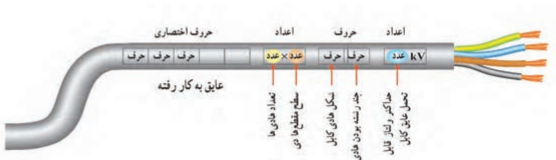
شکل ۲-۱ - مشخصات فنی یک نوع کابل
