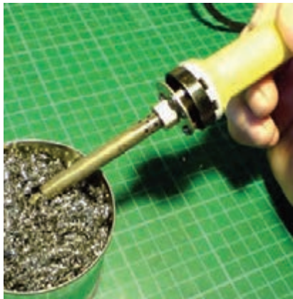
شکل ۴۲-۱- تمیز کردن نوک هویه با اسفنج مخصوص
