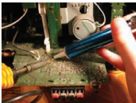
شکل ۸۴-۱- مراحل ذوب شدن و مکش قلع
