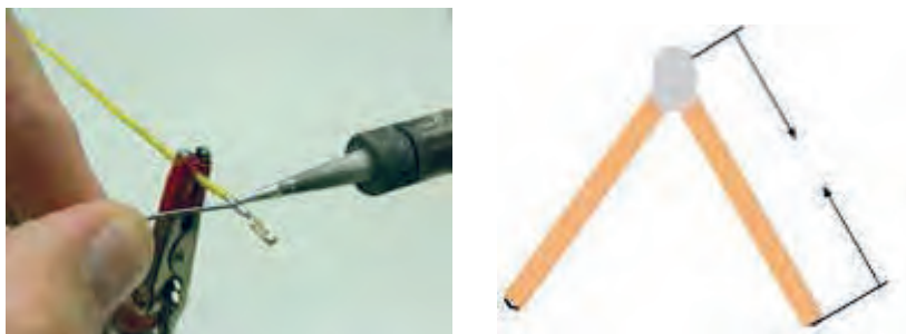
شکل ۱-۵۷- ساخت زاویه ۳۰ درجه
