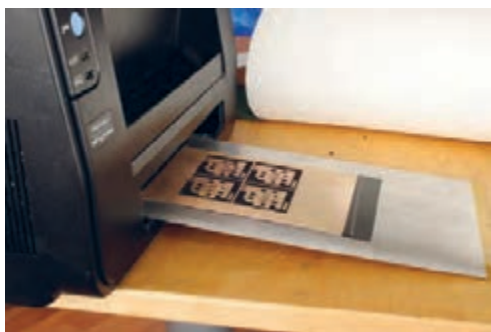
شکل ۵-۷- چاپ طرح مدار چاپی با دستگاه چاپ گر
