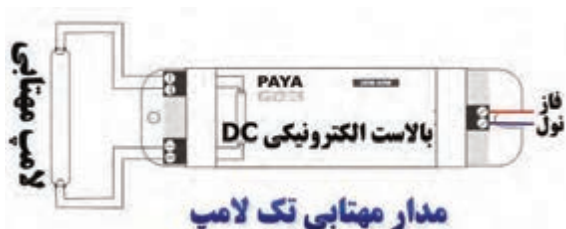
شکل ۶۱-۲- لامپ فلورسنت با انواع بالاست
