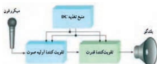
شکل ۴-۱۷- بلوک دیاگرام آمپلی فایر صوتی
