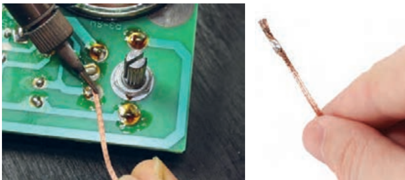
شکل ۸۰-۱- برداشتن قلع از روی فیبر
