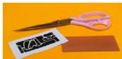
شکل ۷-۷- برش طرح مدار چاپی از کاغذ
