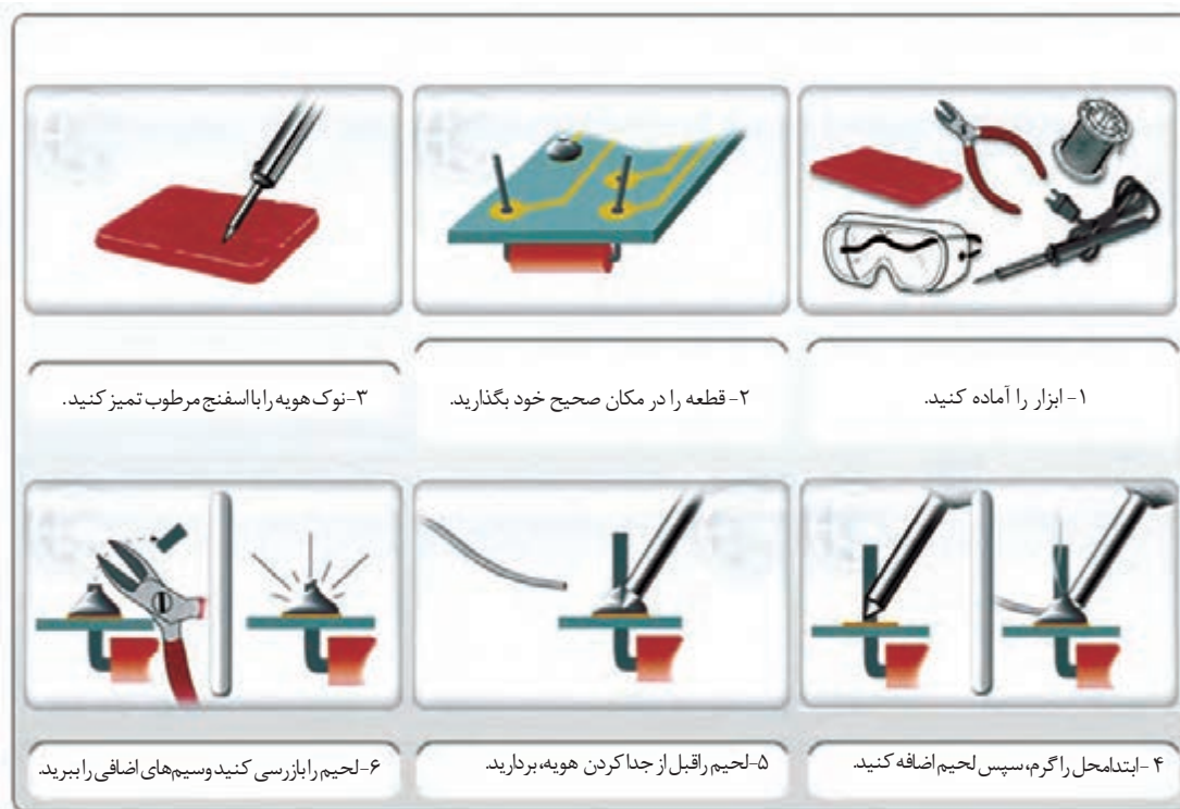
شکل ۹۰-۱- اینفو گرافی مراحل مونتاژ قطعه روی برد مدار چاپی
