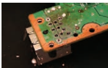
ب- برداشتن لحیمها و آزاد کردن پایهها
