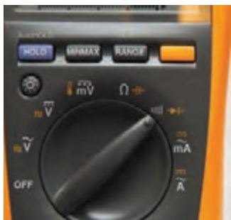
شکل ۳-۵- مولتی متر دیجیتالی در حالت آزمایش دیود
