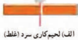
شکل ۵۰-۱- لحیم‌کاری صحیح و غلط
