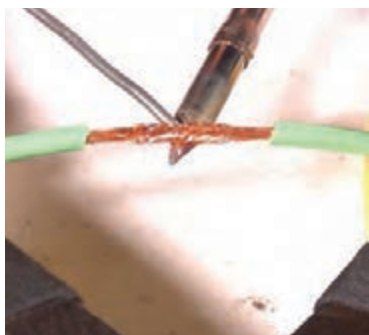
شکل ۴۹-۱- لحیم یک اتصال با سیم افشان
