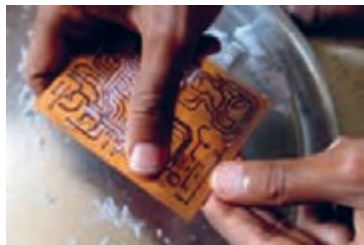
شکل ۱۱-۷- جدا کردن کاغذ از سطح روی فیبر
