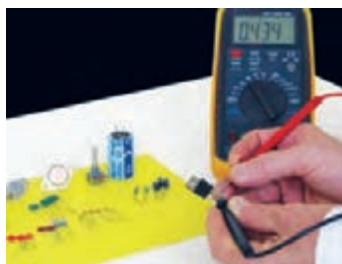
شکل ۳-۷- اطمینان از سالم بودن قطعات
