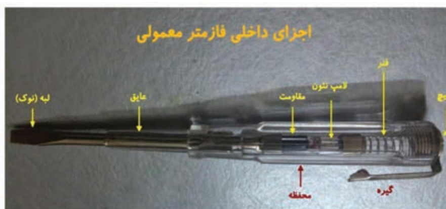
شکل ۲-۳۷- ساختمان داخلی فازمتر
