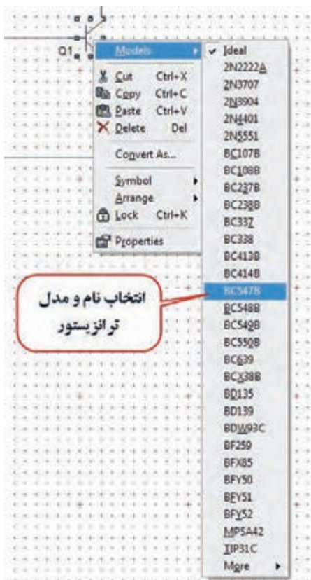
شکل ۱۹-۶- نحوه انتخاب نام و مدل ترانزیستور
