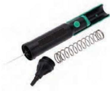
شکل ۸۹-۱ - باز کردن قلع کش پیستونی
