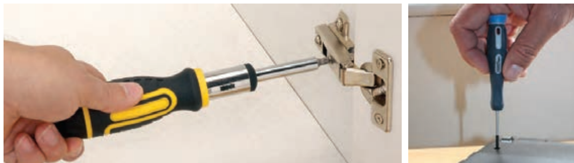
شکل ۳۱-۱- چگونه صحیح در دست گرفتن پیچ گوشتی
