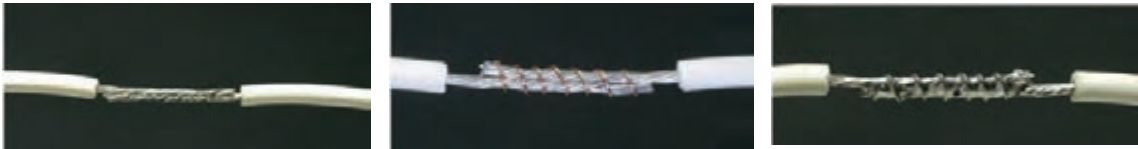
شکل ۶۰-۱- اجرای یک اتصال ساده
