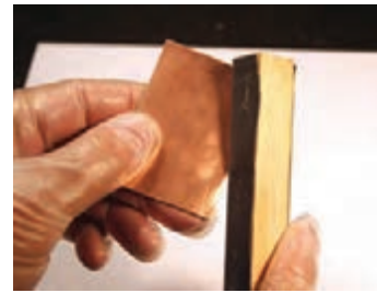
شکل ۶-۳- پرداخت کردن لبه فیبر
