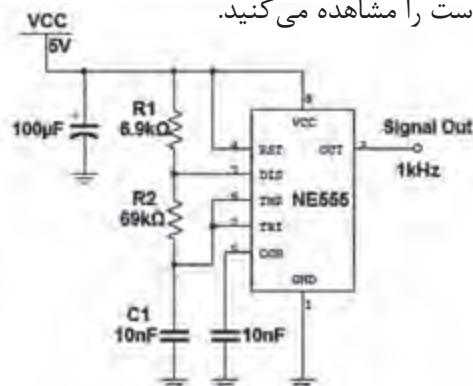
شکل ۲۷-۲- مدار مولد موج مربعی با آی سی ۵۵۵
