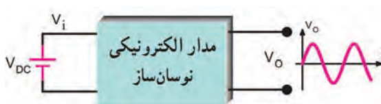
شکل ۶-۲۳ نقشه بلوکی نوسان‌ساز سینوسی
