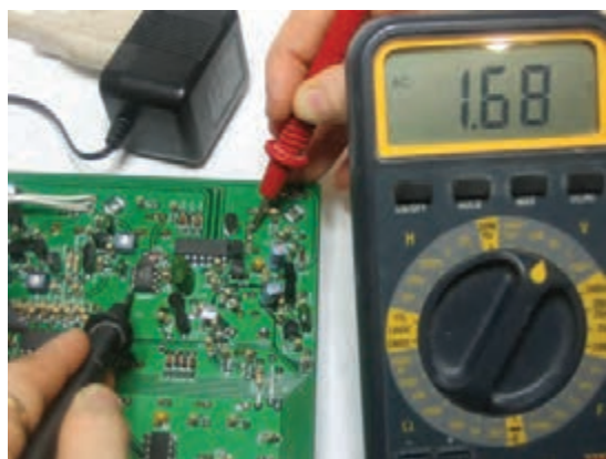
شکل ۵-۵- ولتاژگیری در مدار
