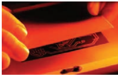
شکل ۳-۲۱- قرار دادن فیبر روی نقشه
