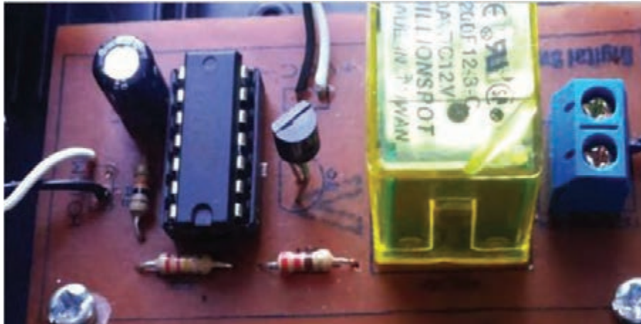
شکل ۹۶-۴ مدار مونتاژ شده کلید الکترونیکی
