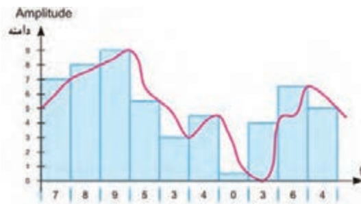
شکل ۶-۷۰ نمونه‌برداری از سیگنال آنالوگ
