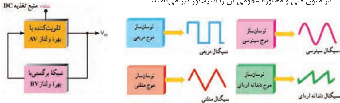
شکل ۶-۲۵ بلوک دیاگرام کلی نوسان ساز
