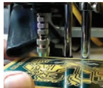
شکل ۳-۲۹- سوراخ کاری فیبر مدار چاپی
