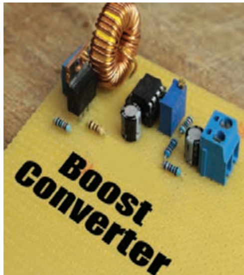
شکل ۳۱-۲- یک نمونه مدار مبدل DC به DC
