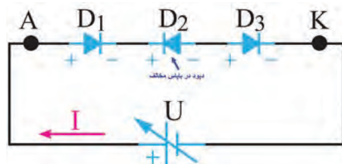
شکل ۷-۴ دیود چهار لایه در بایاس موافق
