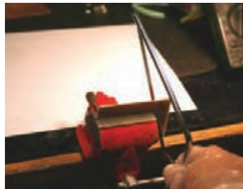
شکل ۷-۳- بریدن فیبر با اره آهن‌بر
