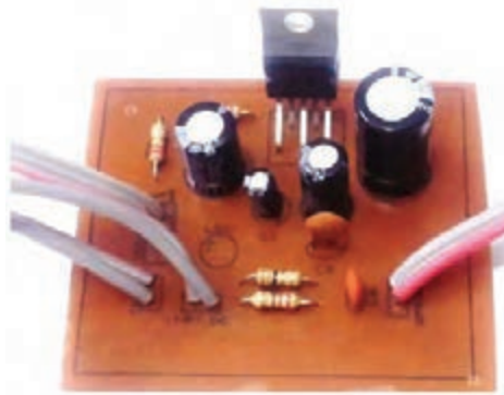
شکل ۴-۹۰- مدار مونتاژ شده تقویت کننده
