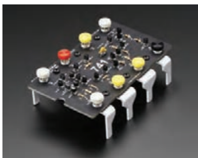
شکل ۴-۵۴- مدار داخلی آی سی ۷۴۱ با قطعات مجزا
