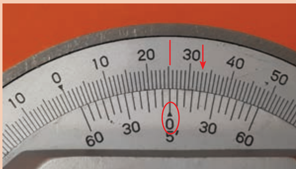
شکل ۱۱- اندازه‌گیری با زاویه‌سنج
