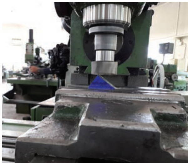
شکل ۱۸- خط‌کشی و بستن قطعه در گیره
