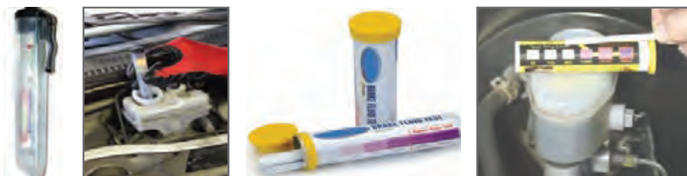
شکل ۶- آزمایش کیفیت مایع هیدرولیک ترمز
