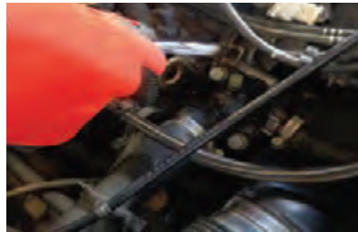
۱ روی پیچ هواگیری لوله شفاف بسته، سپس پیچ هواگیری شل شود.
