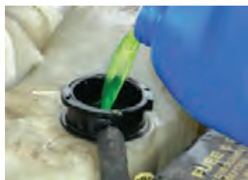
۹ اگر سطح مایع درون مخزن انبساط کمتر از Min باشد با افزودن مخلوط آب و ضدیخ به اندازه مناسب سطح مایع تنظیم شود.
