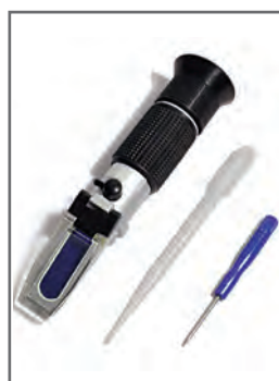
رفلکتومتر، اندازه‌گیری جرم حجمی الکترولیت
