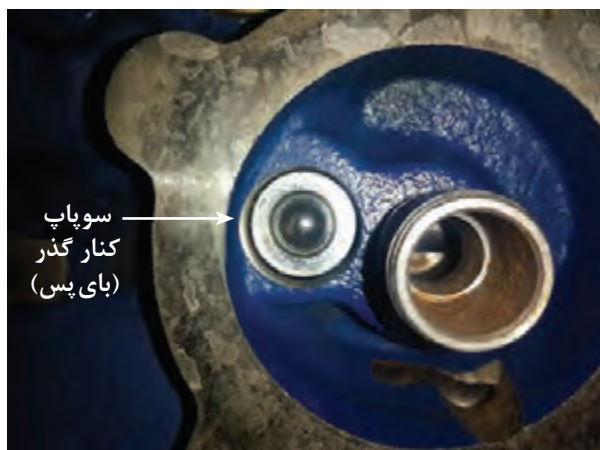
شکل ۱۶- سوپاپ کنار گذر گنجانده شده در مدار روغن کاری موتور
