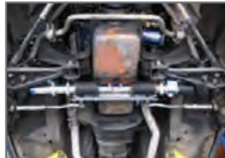
۳ پس از قرار گرفتن خودرو روی جک بالا، از زیر خودرو مدار هیدرولیک فرمان بررسی شود.
