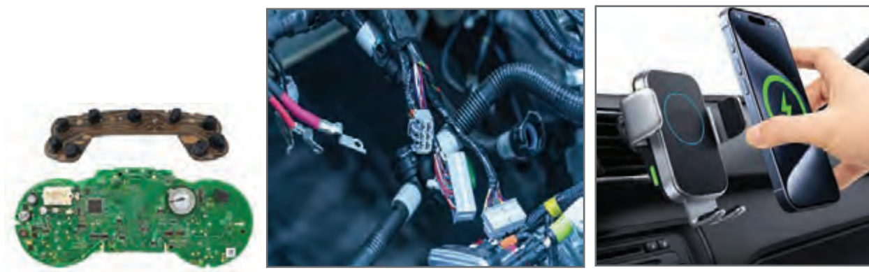
شکل ۱- روش‌های انتقال جریان برق
