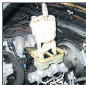
شکل ۱۴- عوض کردن و هواگیری سیستم هیدرولیک ترمز با دستگاه تزریق تحت فشار
