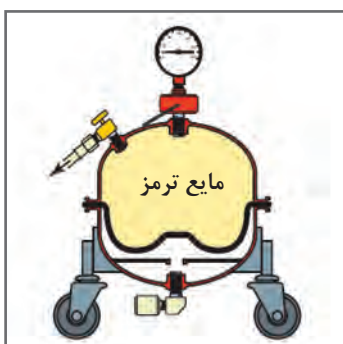
شکل ۱۴- عوض کردن و هواگیری سیستم هیدرولیک ترمز با دستگاه تزریق تحت فشار
