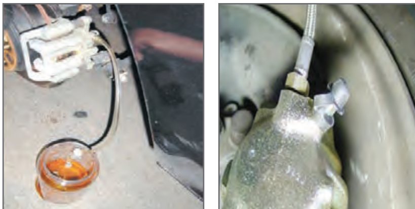
شکل ۱۰- عوض کردن مایع هیدرولیک ترمز به روش دستی و بدون دستگاه خلأ
