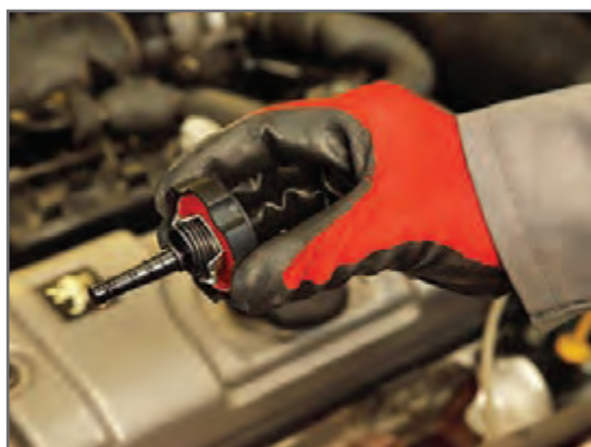
۴ از روی شاخص سطح روی بدنه یا در مخزن، سطح مایع موجود در مخزن بررسی شود. در صورت کم بودن سطح مایع به مرحله نشتی یابی رفته و پس از نشتی یابی به مرحله سرریز مراجعه شود.
