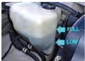
۸ کنار مخزن انبساط دو نشانه Max(full) و Min(low) وجود دارد. سطح مایع باید بین این دو خط باشد.
