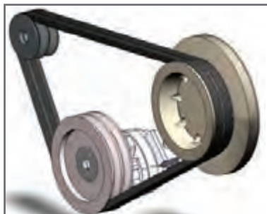
شکل ۲- انتقال توان با تسمه و پولی
