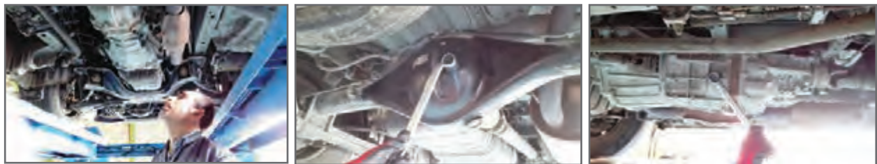
شکل ۴۸- بررسی و آچارکشی بخش‌هایی از سیستم انتقال توان یک نمونه خودرو
