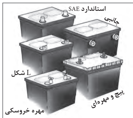
شکل ۳۱- چند نمونه بست باتری و روش اتصال آن به قطب‌ها
