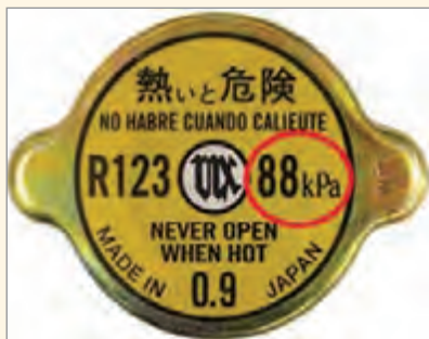
شکل ۲۲- محل نوشته شدن فشار کارکرد روی در چند رادیاتور
