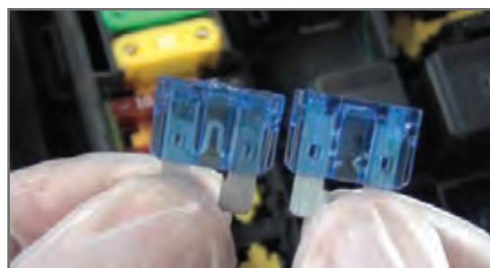
شکل ۱۶- مقایسه فیوز تیغه‌ای سالم و سوخته
