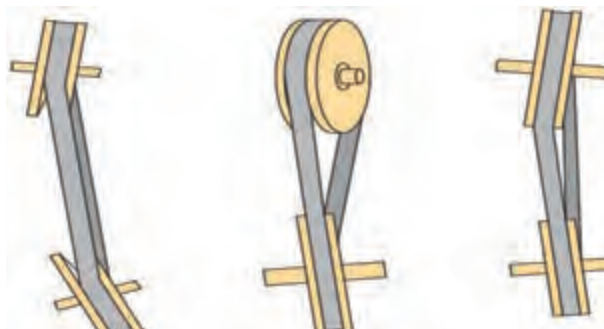
شکل ۱۵- هم‌راستا نبودن محوری و زاویه‌ای پولی‌ها
