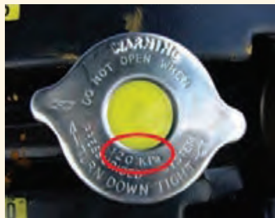
شکل ۲۲- محل نوشته شدن فشار کارکرد روی در چند رادیاتور
