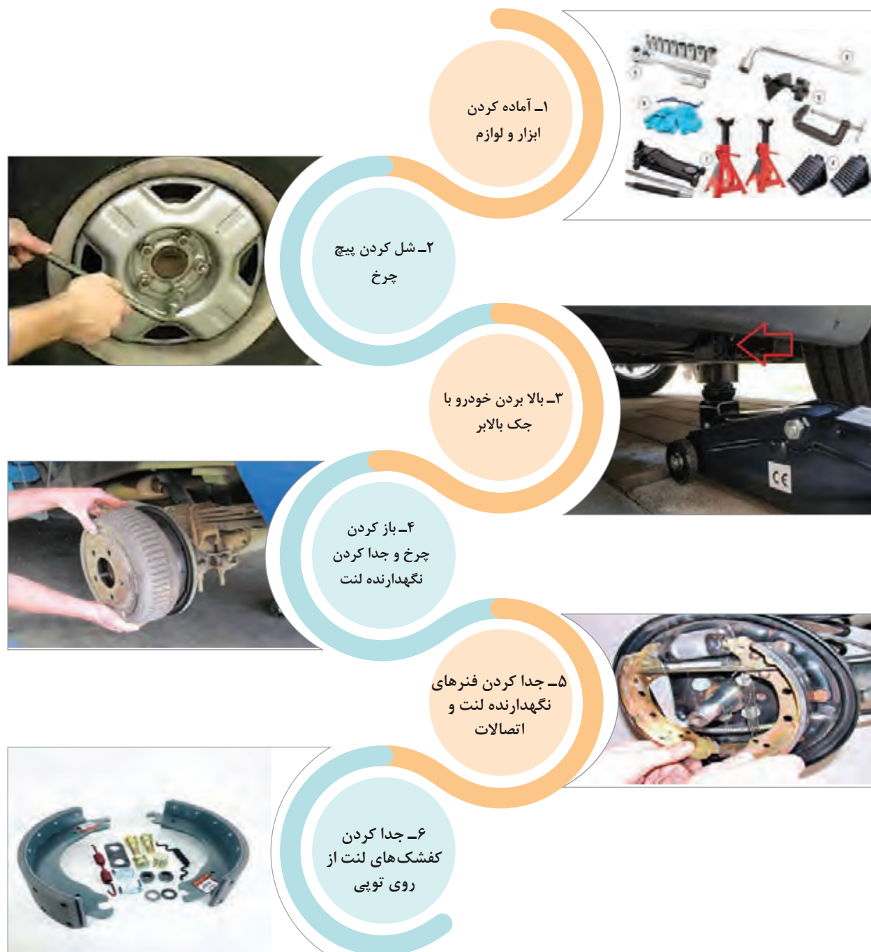
شکل ۱۱- مراحل باز کردن و تعویض لنت کفشکی
