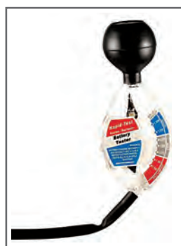
هیدرومتر، اندازه‌گیری جرم حجمی الکترولیت
