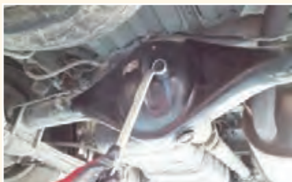
شکل ۵- روش بررسی سطح و رنگ روغن دیفرانسیل عقب محرك
