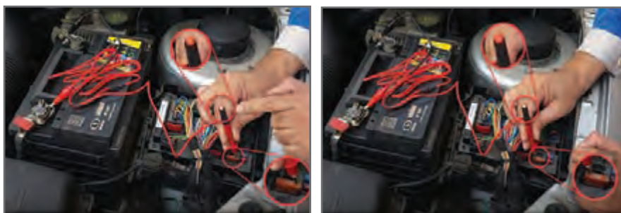
شکل ۱۷- روش بررسی فیوز با تست لامپ مثبت/منفی
