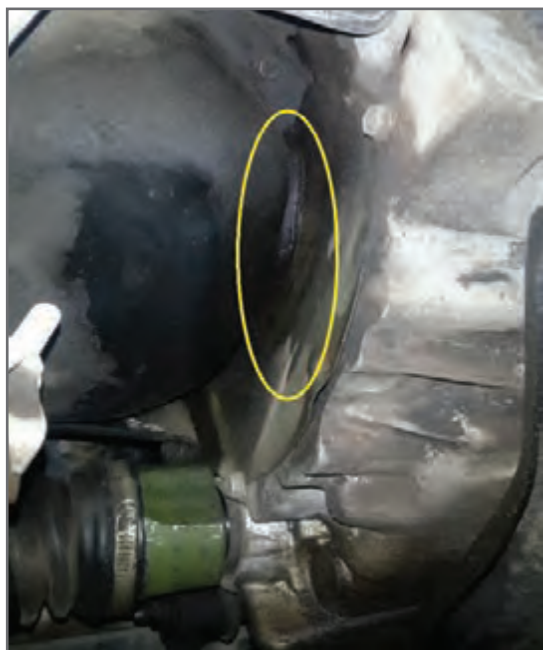
شکل ۶- قرار گرفتن خودرو روی جک بالا بر و دیدن محل های احتمالی نشتی
