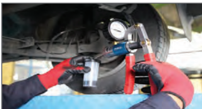
شکل ۱۲- نمونه‌ای از دستگاه خلأی هواگیری سیستم ترمز
