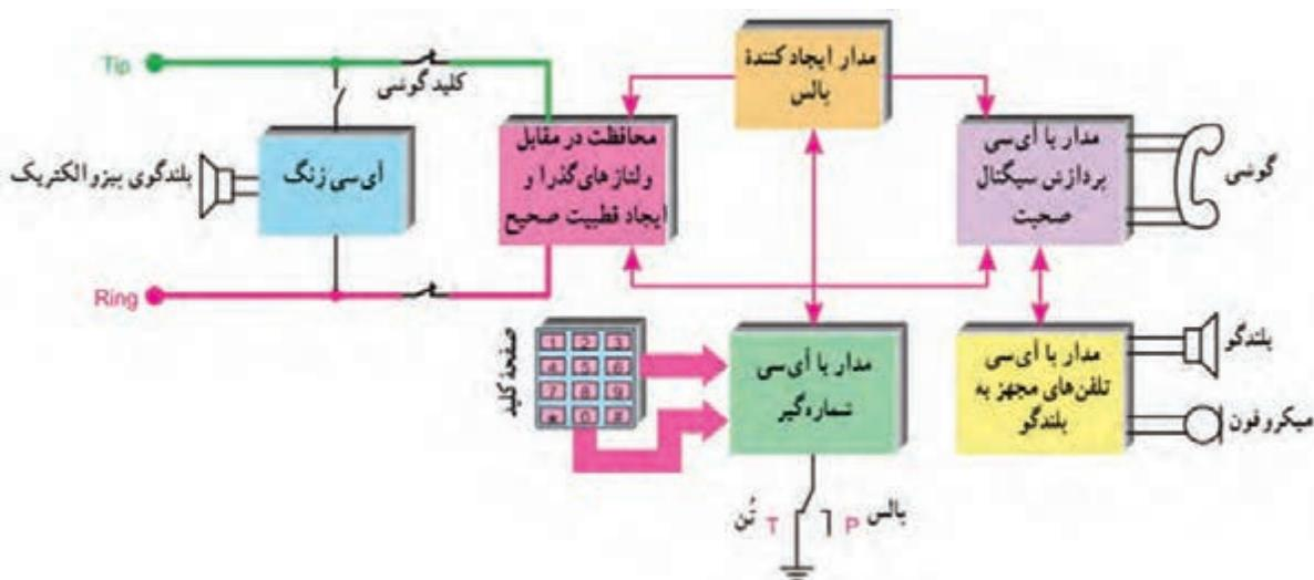
شکل ۵-۱۹- بخش های مختلف تلفن الکترونیکی
