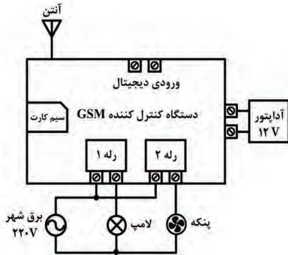
شکل ۲-۵۵- سیم کشی دستگاه کنترل کننده GSM
