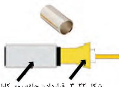
شکل ۳-۲۲- قراردادن حلقه روی کابل
