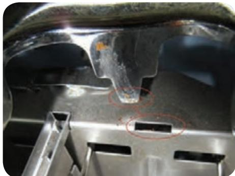
شکل ۶-۵۸-۶ خار نر و ماده جهت اتصال
