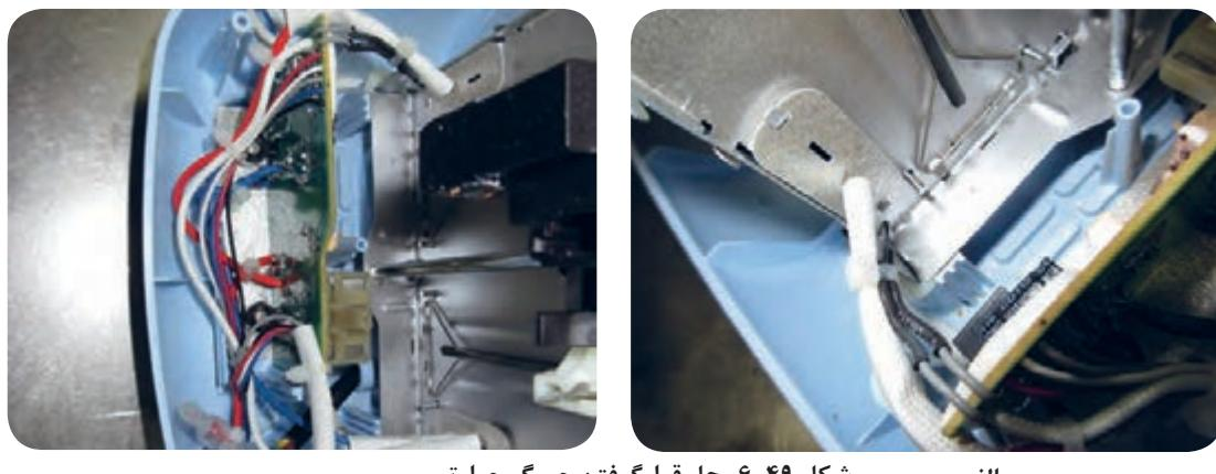
شکل ۶-۴۹-۶ محل قرار گرفتن حسگر حرارتی الف ب
