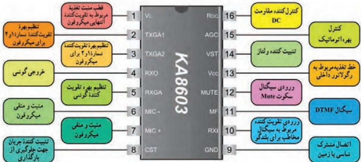
شکل ۵-۳۰- مشخصات پایه‌های ای‌سی KA8603
