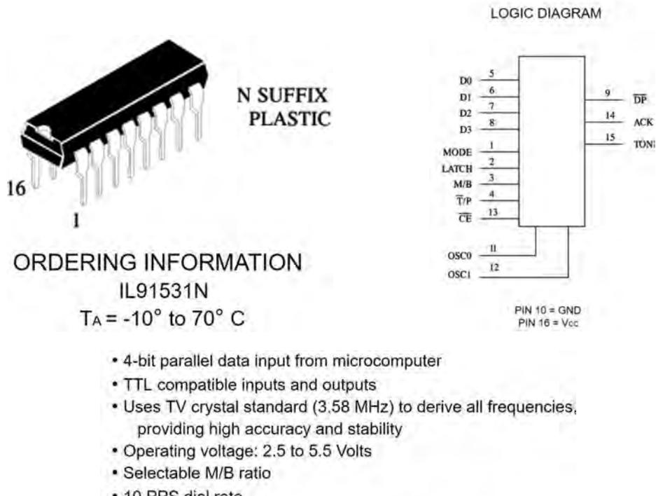
شکل ۵-۲۷ قسمتی از برگه اطلاعات یک نوع آی‌سی شماره گیر
