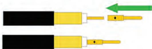
شکل ۳-۲۳- چگونگی اتصال فیش به کابل
