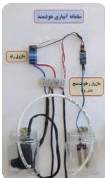
شکل ۲-۵۲- نحوه سیم‌کشی ماژول دماسنجه YL-۶۹
