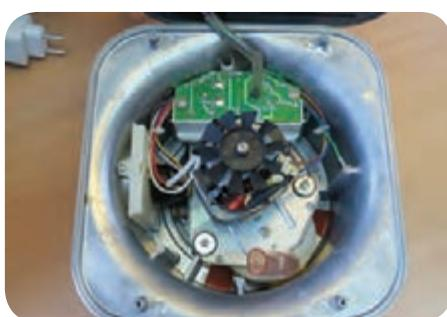
شکل ۱-۲۴-مотор، برد الکترونیکی و پروانه
