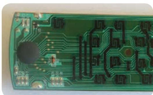
شکل ۱-۶- قطعات روی برد دستگاه ریموت کنترل
