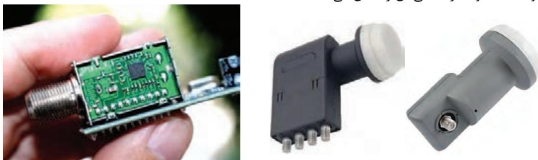
شکل ۴-۲۵- دو نوع LNB و مدار داخلی آن
