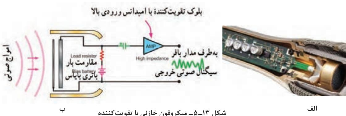
شکل ۵-۱۳- میکروفون خازنی با تقویت کننده
