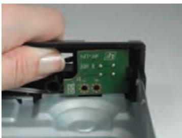
شکل ۶-۳۴-۶ فشاردادن زائد پلاستیکی
