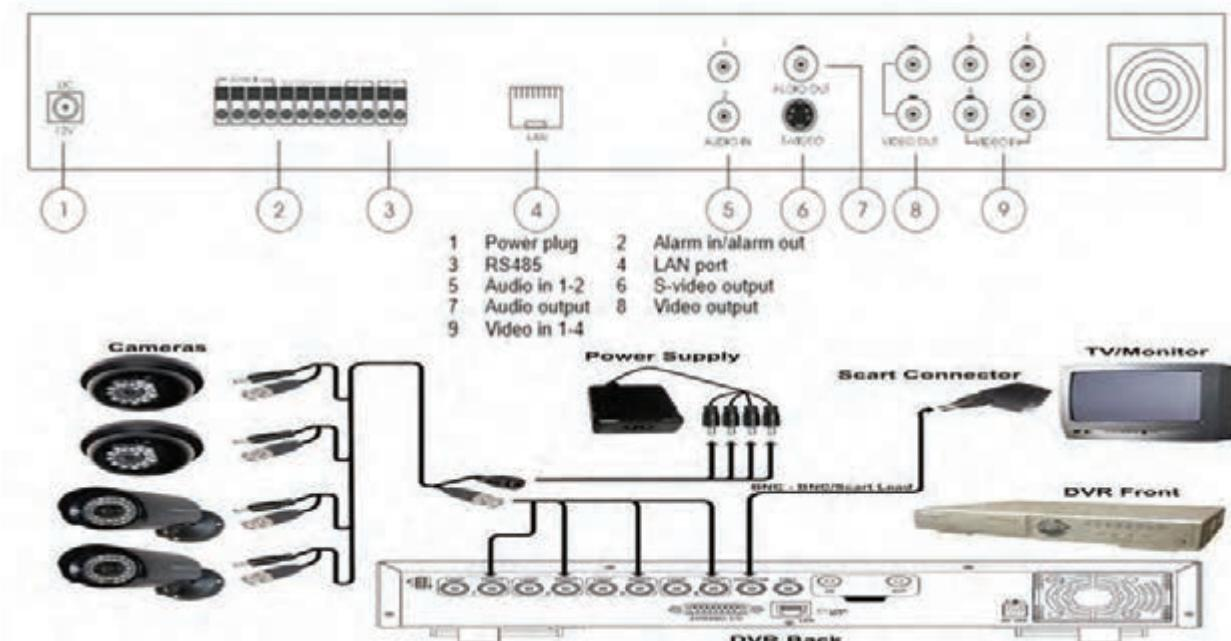
شکل ۳-۲۳- نمای پشتی یک نمونه دستگاه DVR
