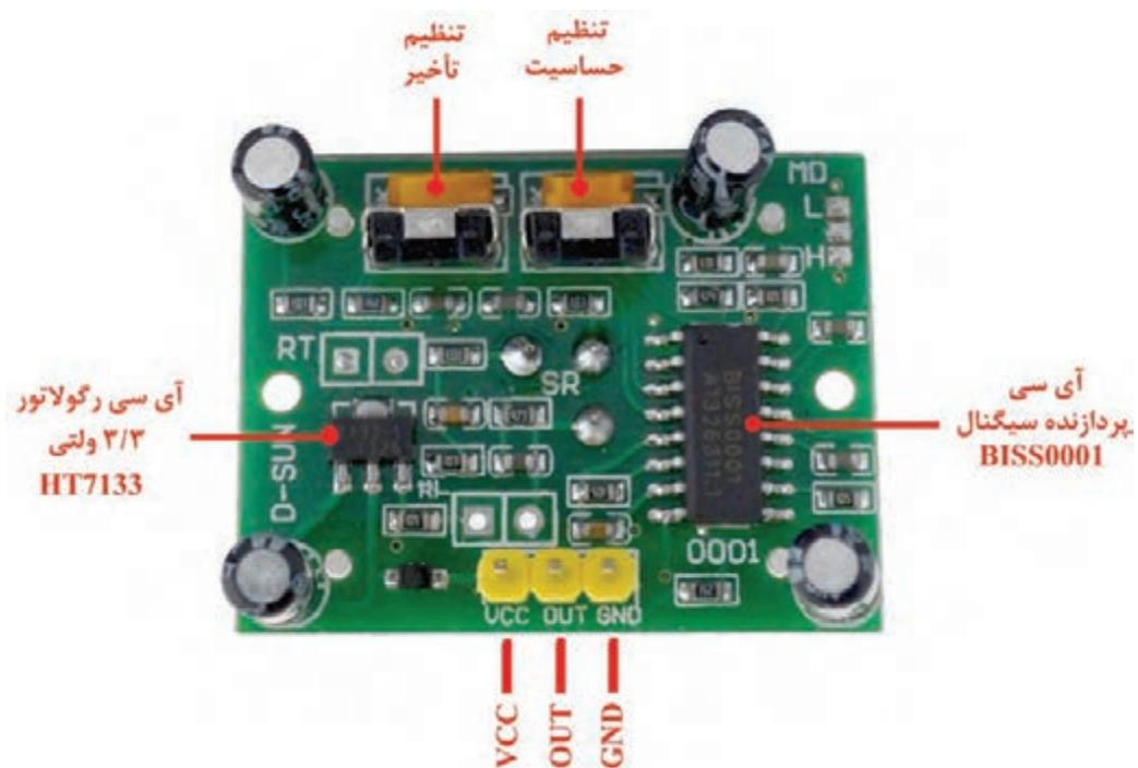
شکل ۲-۳۳- برد مدار چاپی مژول حسگر حرکتی HC-SR501
