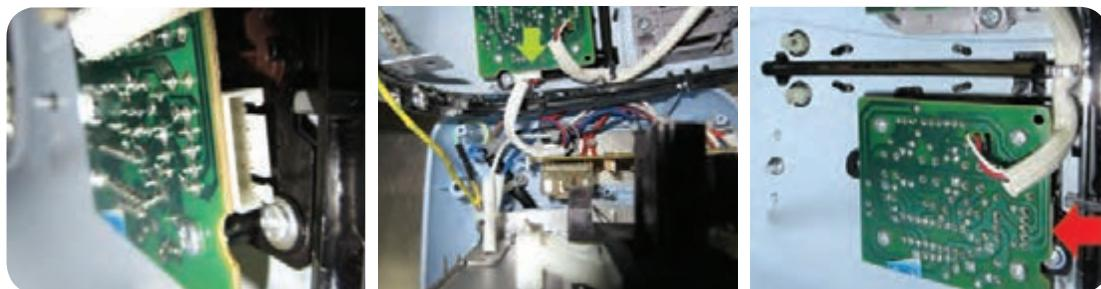
شکل ۶-۵۰-۶ عُبرد الکترونیکی شکل ۶-۵۱-۶ محل اتصال سوکت به بُرد الکترونیکی شکل ۶-۵۲-۶ سوکت از بُرد جدا شده است
