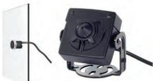
شکل ۳-۱۶- دو نمونه دوربین پین هول
