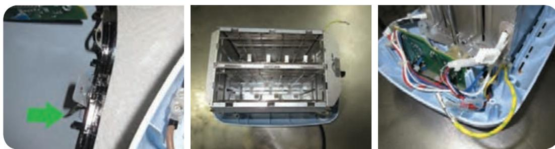
شکل ۶-۵۳-۶ سیم اتصال زمین شکل ۶-۵۴-۶ فیش اتصال زمین شکل ۶-۵۵-۶ سیم اتصال زمین
