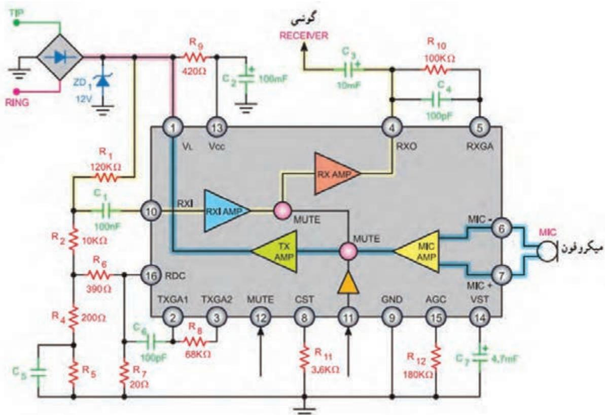
شکل ۵-۳۱- مدار ساده مکالمه
