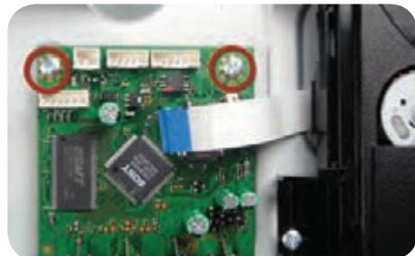
شکل ۶-۲۱ باز کردن پیچ های اتصال دهنده برد پردازشگر به کف دستگاه
