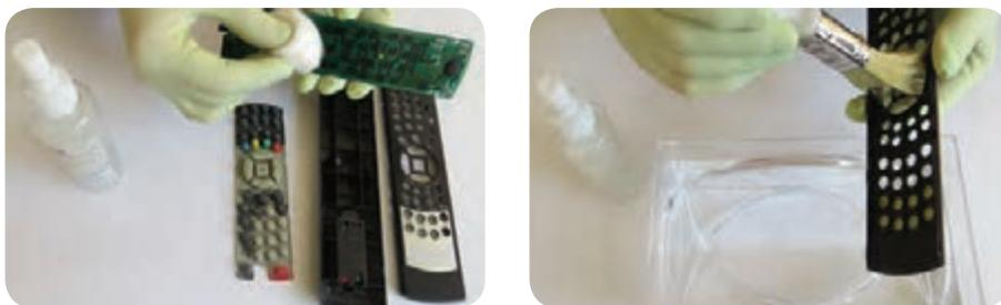
شکل ۱-۱۰- تمیز کردن کنکات‌ها با الکل
