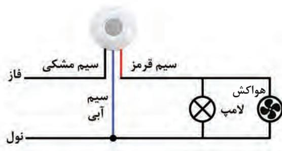
شکل ۲-۳۰- اتصال حسگر حرکتی به شبکه و لامپ و هوایکش
