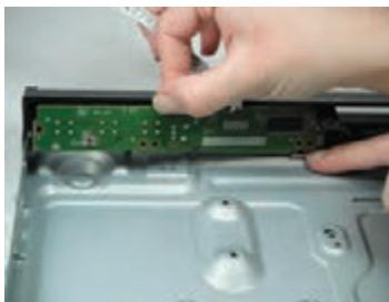
شکل ۶-۳۱-۶ فشاردادن زائد و خارج کردن برد
