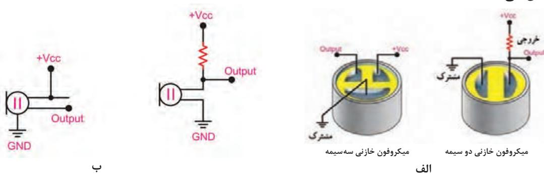
شکل ۵-۱۴- میکروفون خازنی با اتصال تغذیه
