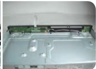
شکل ۶-۲۹-۶ باز کردن ۳ پیچ پنل کوچک
