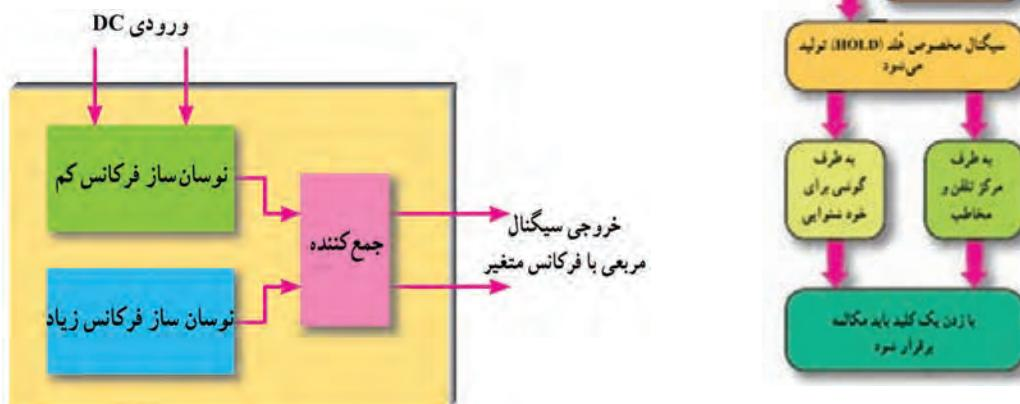
شکل ۵-۳۴- بلوک دیاگرام مدار داخلی آی سی
