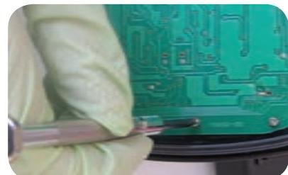
شکل ۱-۱۶- باز کردن پیچ‌های اتصال بدنه
