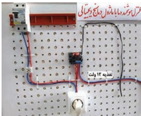
شکل ۲-۴۵ نحوه سیم‌کشی مژول دماسنج WX-۱۰۱W
