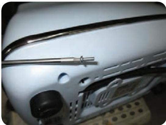
شکل ۶-۴۳- استفاده از ابزار خاص برای پیچ‌های بازشده
