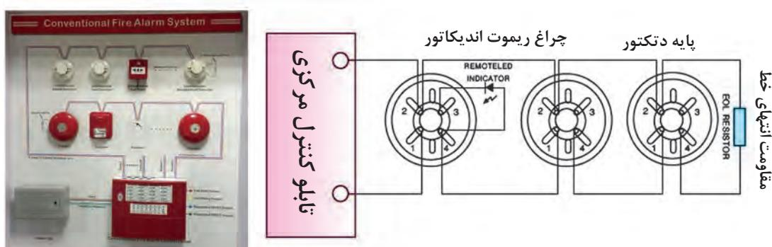
شکل ۳-۵۲- نقشه اتصال آشکارسازها به تابلو کنترل مرکزی
