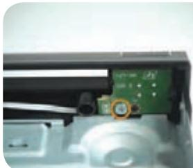
شکل ۶-۲۷-۶ قراردادن برد مدار چاپی
