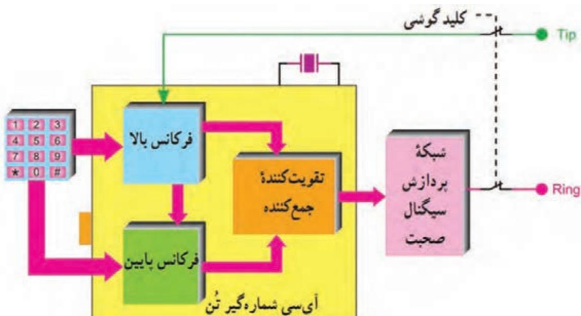
شکل ۵-۲۵- بلوک دیاگرام مدار آی سی شماره گیر
