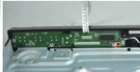
شکل ۶-۲۸-۶ باز کردن ۳ پیچ پنل بزرگ
