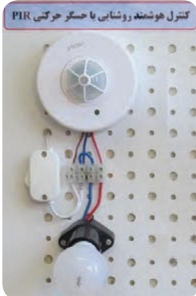
شکل ۲-۲۹- نحوه سیم‌کشی حسگر حرکتی PIR
