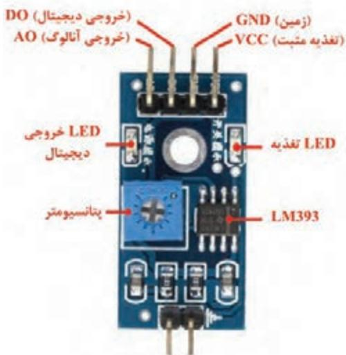
شکل ۲-۵۰ - اجزای برد الکترونیکی مژول رطوبت سنج YL-69
