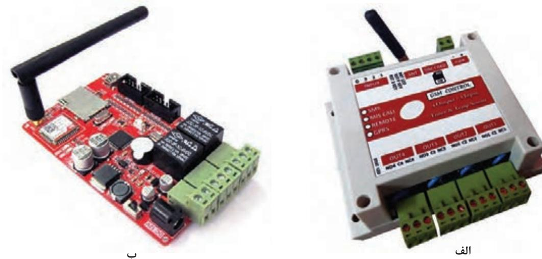
شکل ۲-۵۴ دو نمونه دستگاه کنترل کننده GSM
