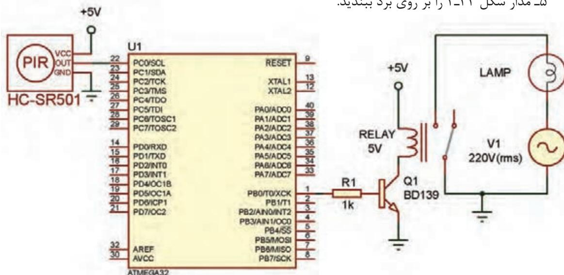
شکل ۲-۳۴- نقشه الکترونیکی اتصال مژول HC-SR501 به میکروکنترلر
