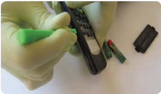
شکل ۱-۸ آزاد کردن خارهای قاب دستگاه ریموت کنترل
