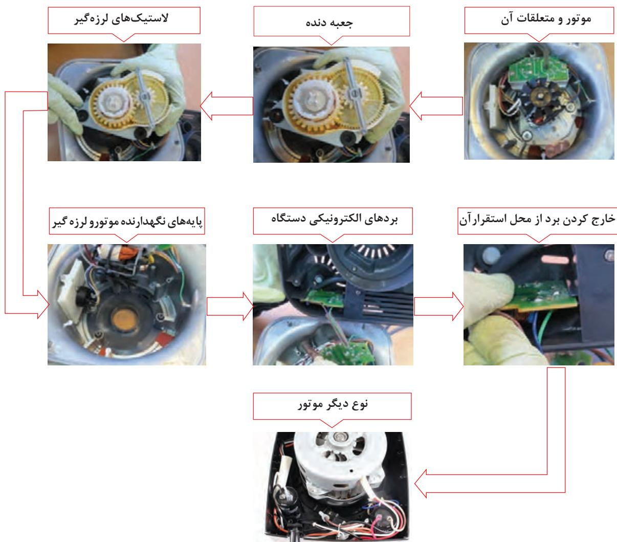
شکل ۱-۲۷- اینفوگرافی جدا کردن برد الکترونیکی دستگاه غذاساز
