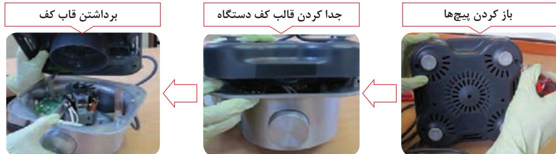
شکل ۱-۲۲-اینفوگرافی باز کردن کف دستگاه
