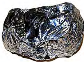
شکل ۶. سیلیسیم شبه فلزی است که ظاهری براق مانند فلزات دارد ولی نیمه رسانا محسوب می‌شود.
