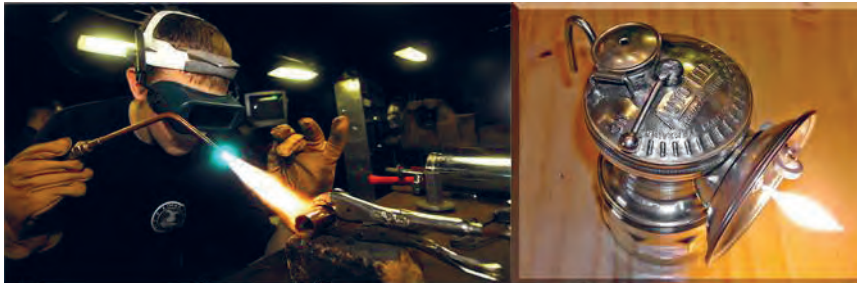
شکل ۷. استفاده از گاز اتیلن (استیلن) در برشکاری فلزات و لامپ‌های کاربردی.
