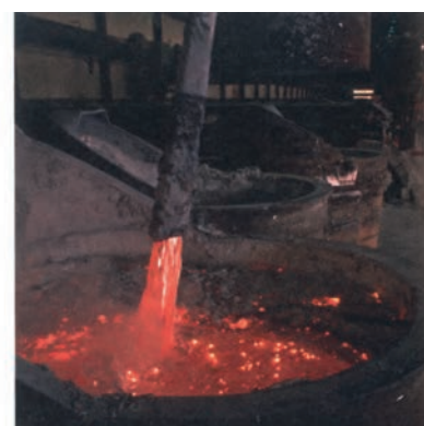
شکل ۱۸- فرایند هال برای تولید آلومینیم از \text{Al}_2\text{O}_3
