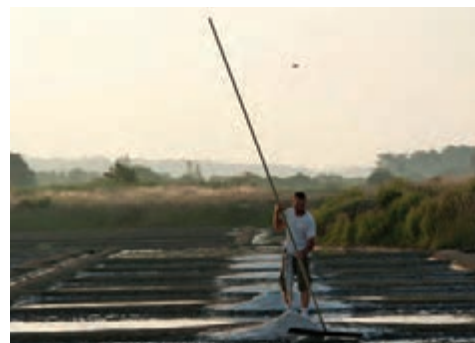
شکل ۱۳- استخراج و جداسازی سدیم کلرید به روش تبلور
