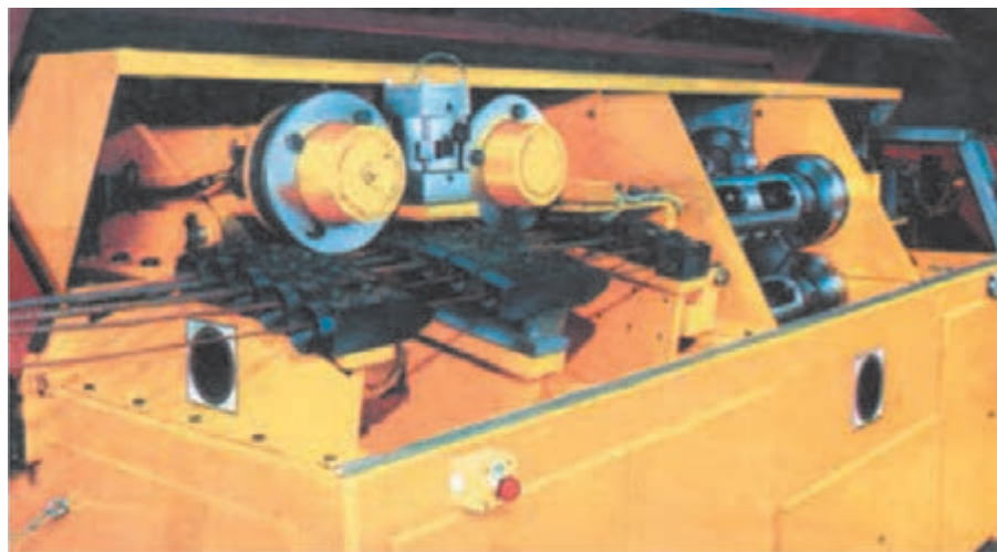
شکل ۲۹ - دستگاه کشش برقی برای صاف کردن میلگرد ▲
