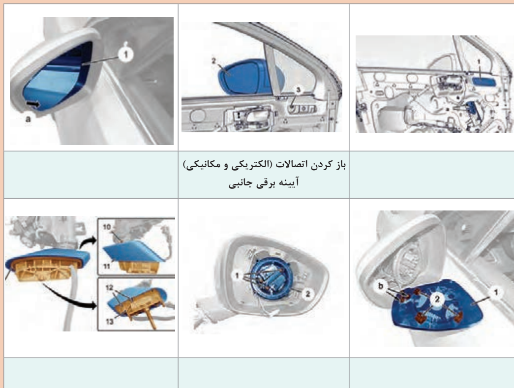
شکل ۲۰- نکات مهم باز کردن، بررسی و بستن مجموعه آئینه جانبی الکتریکی
