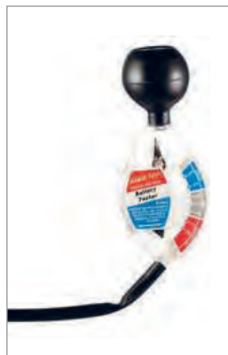
هیدرومتر، اندازه‌گیری جرم حجمی الکترولیت
