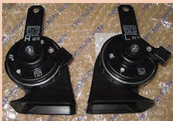
شکل ۴۸- درج L و H روی دستگاه بوق
