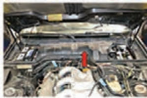
۲- پوشش پلاستیکی پایین شیشه جلور را باز کنید تا دسترسی به موتور برف پاک‌کن ممکن شود.
