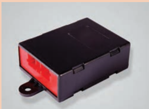
شکل ۹- انواع یونیت شیشه بالابر
