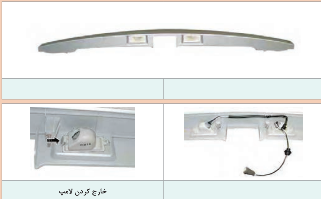
شکل ۳۵- روش باز کردن و بستن چراغ پلاک
