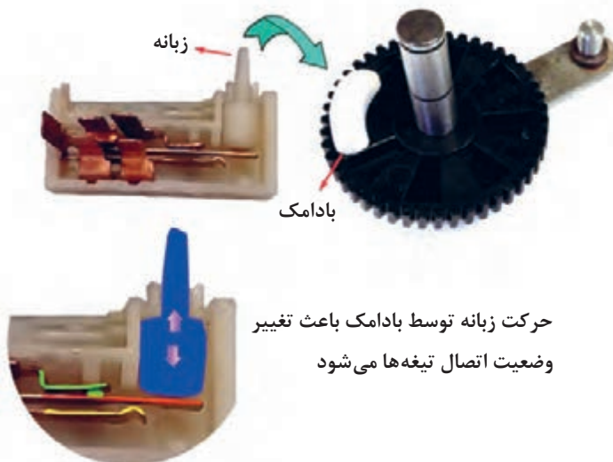
شکل ۸- کلید پارک از نوع پلاتین و بادامک
