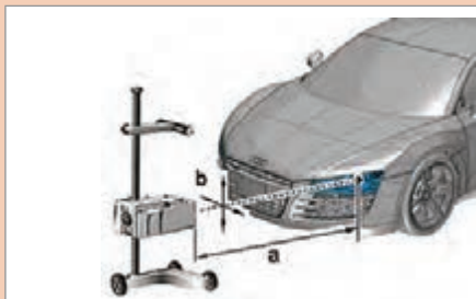
۲- تنظیم فاصله a و b براساس راهنمای کاربر دستگاه
