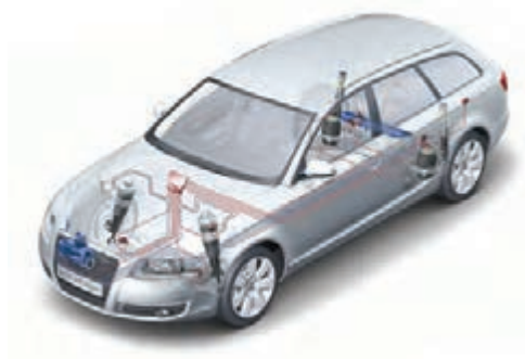
شکل ۲۸- سیستم تعلیق فعال
