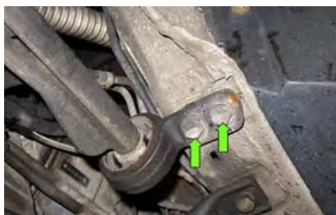
گشتاور سنجی اتصالات پیچ و مهره ای
