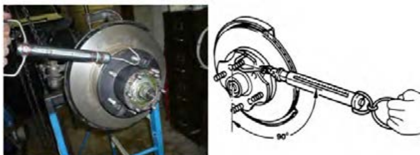
شکل ۱۸- بررسی توپی و بلبرینگ یا رولبرینگ
