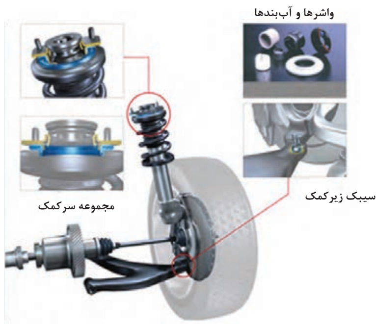
شکل ۳۲- برخی نقاط قابل تعمیر تعلیق مک فرسون
