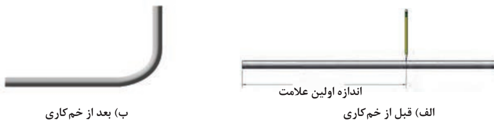
شکل ۳۶- روش تقریبی برای خم‌کاری
