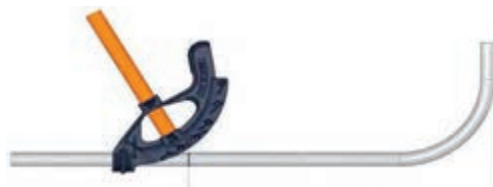
شکل ۲۷- اجرای خم دوم
