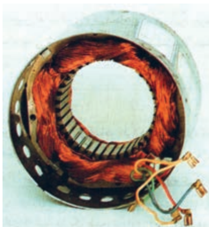
شکل ۷۰- سرسیم‌ها و سیم‌پیچی‌های موتور الکتریکی کولر آبی
