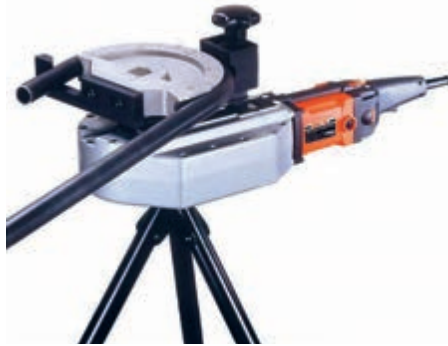
شکل ۱۷- خم کردن لوله
