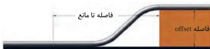
شکل ۳۵- هم‌راستا کردن امتداد لوله
