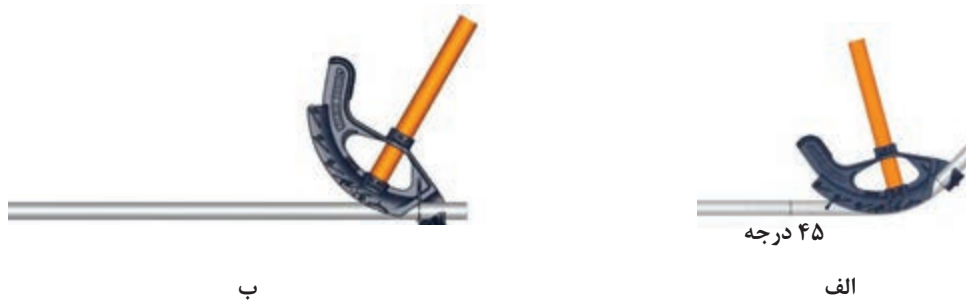
شکل ۳۳- خم انحرافی با لوله خم کن دستی
