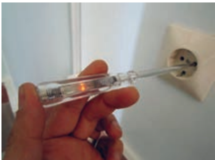
شکل ۴ - کاربرد صحیح فازمتر
