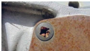
ب) استفاده ناصحیح از آچار پیچ گوشتی
