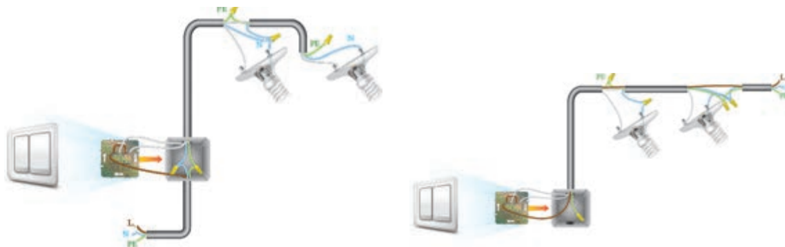
شکل ۲۷ - مدار کلید دورااهه (دوبل)
