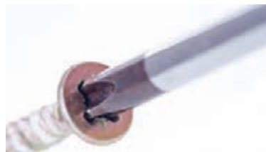
الف) استفاده صحیح از آچار پیچ گوشتی
