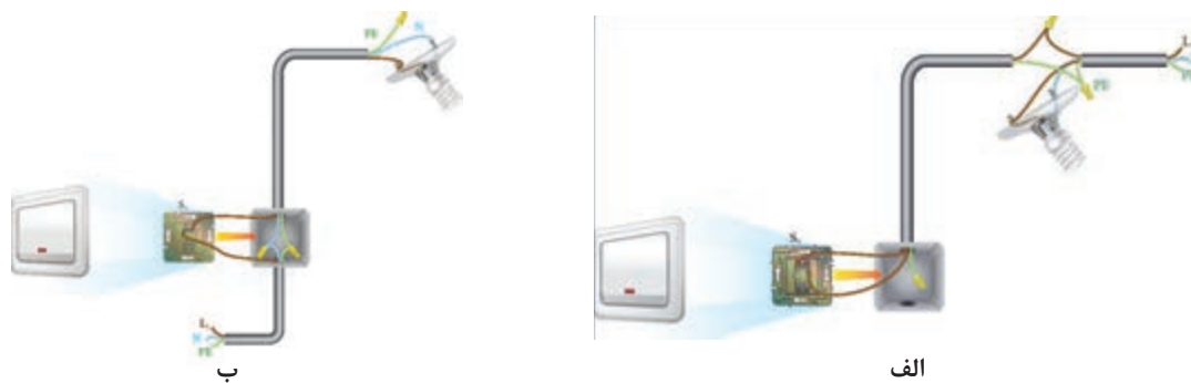
شکل ۲۰ - مدار کلید یک پل
