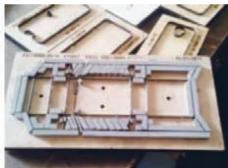
شکل ۱۷- قالب برش تخت
