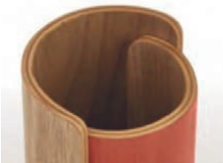
شکل ۱۳- ویژگی انعطاف‌پذیری تخته‌های چند لایه
