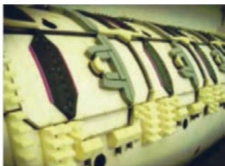
شکل ۱۸- قالب برش گرد یا روتاری
