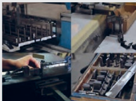
شکل ۱۰۲- خم کن با قطعات مختلف آن
