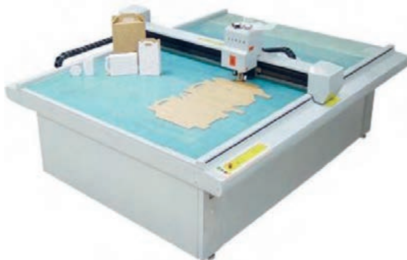
شکل ۷۰- دستگاه نمونه ساز کاتر پلاتر
