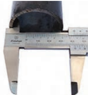
شکل ۴۸ - شاخک‌های داخل‌سنج کولیس
