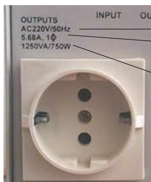
شکل ۱۰- مشخصات فنی یو پی اس
