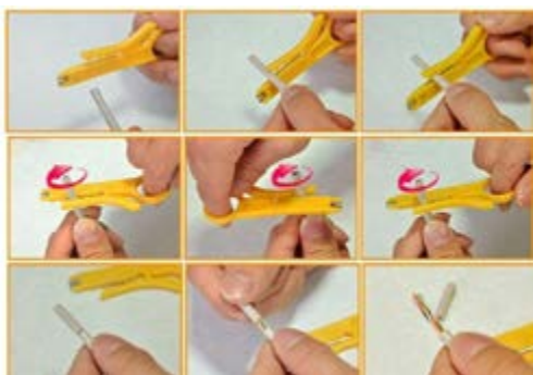
شکل ۷ - روکش برداری کابل
