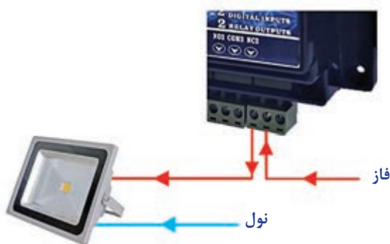
شکل ۲۰- نحوه کنترل دستگاه برقی
