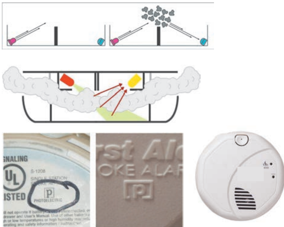
شکل ۳۲ - عملکرد دتکتور دودی و علامت مشخصه آن
