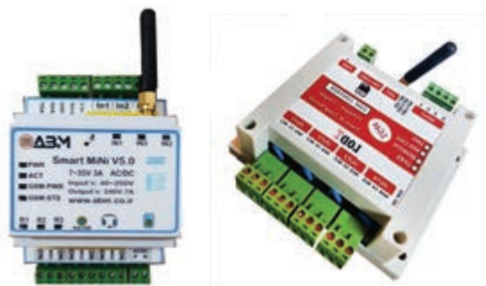
۱۶- سامانه کنترل از راه دور با پیامک
