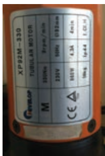
شکل ۱۳- قطر موتور درون نصب برابر ۹۲ میلیمتر است
