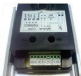
شکل ۲۵- محل تنظیم صدای بلندگو و میکروفون
