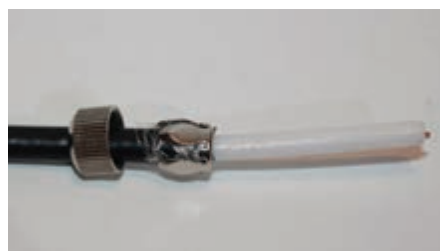
۷- سوزنی را در محل خود قرار داده تا انتها فشار دهید و پیچ آن را محکم ببندید.
