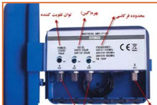
شکل ۱۵- مشخصات فنی یک بوستر یا تقویت کننده
