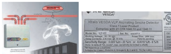
شکل ۳۹- ساختمان دتکتور مکشی و برچسب آن
