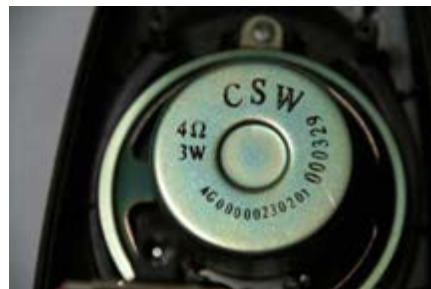
شکل ۹- توان بلندگو و امپدانس
