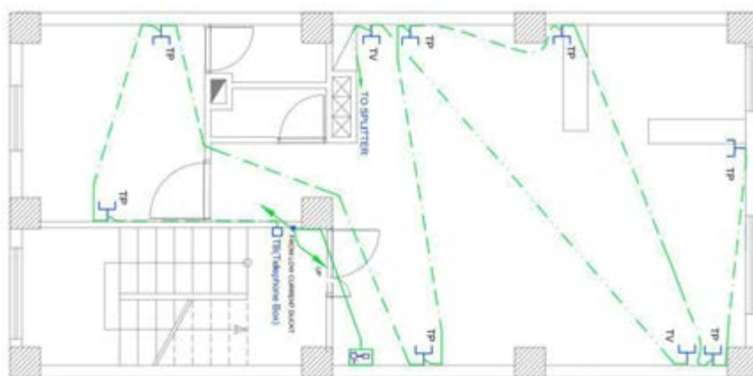
شکل ۱۰ - نقشه سیم‌کشی پریز تلفن و پریز آنتن
