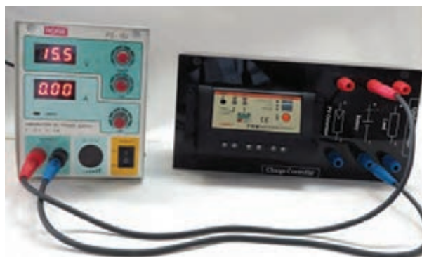
شکل ۱۹- حالت کنترل دشارژ
