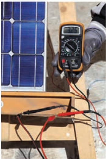
شکل ۱۵-۲- اندازه‌گیری جریان اتصال کوتاه
