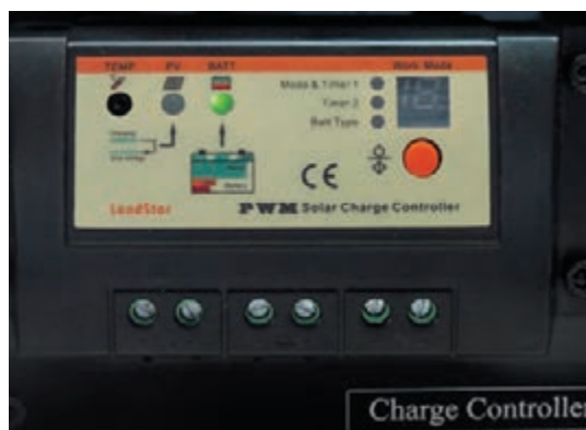
شکل ۳۶- با اتصال باتری LED روشن می شود.
