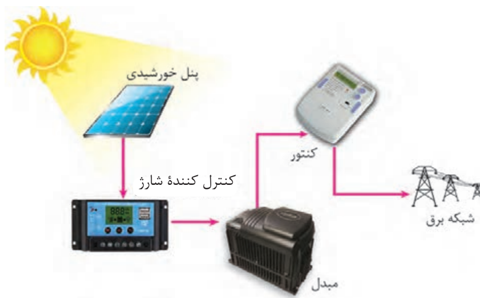
شکل ۵۱- نقشه ارتباط عناصر سیستم فتوولتائیک On_Grid
