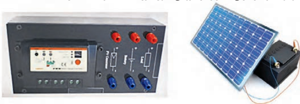
شکل ۱۳- اتصال مستقیم باتری به مدول
