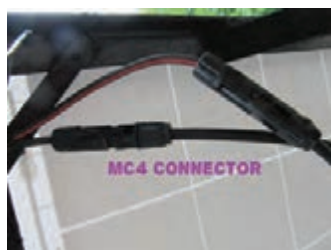
شکل ۲۸- اتصال کانکتور MC۴
