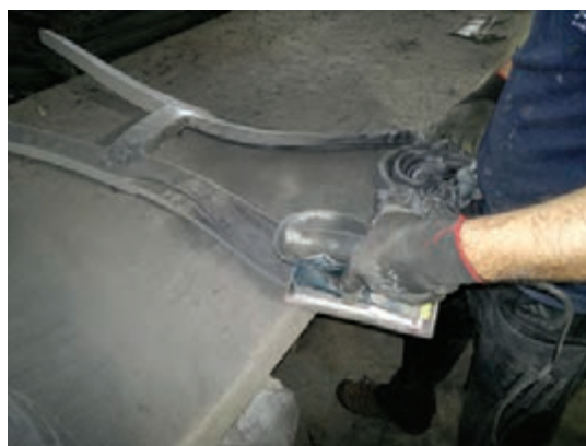
شکل ۵-۳۱ پرداخت پشت صندلی با سنباده لرزان
