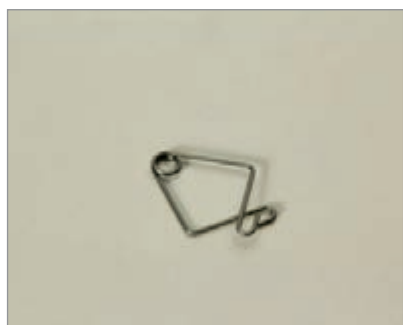
شکل ۳-۱۲۸ - سنجاق آویز بار (تا یک کیلوگرم)
