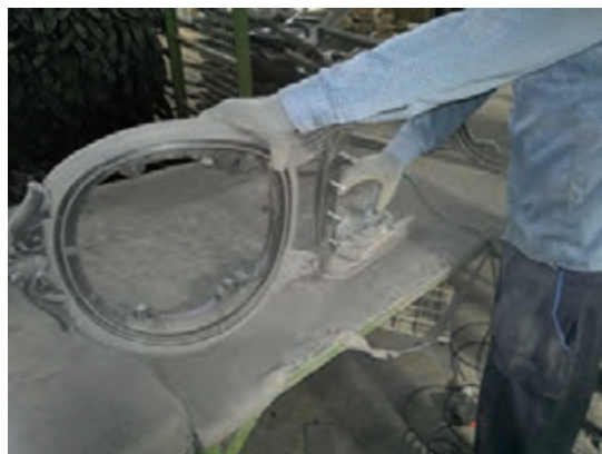
شکل ۵-۳۰ پرداخت با سنباده لرزان
