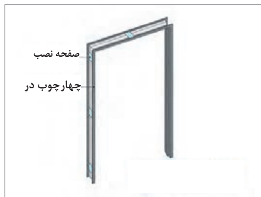
شکل ۱-۱۰۹- محل قرارگیری صفحات نصب در چهارچوب‌های فلزی شکل ۱-۱۱۰- مقدار B در حدود ۱/۵ سانتی‌متر می‌باشد
