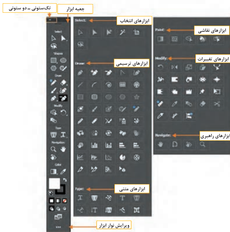
شکل ۵- جعبه ابزار و قسمت‌های مختلف آن
