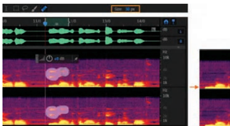
شکل ۶۶- ترمیم محدوده فرکانسی با کمک ابزار Spot Healing Brush
