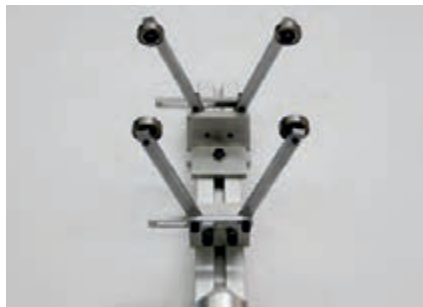
شکل ۱۵-۵ سیستم حرکتی قالب
