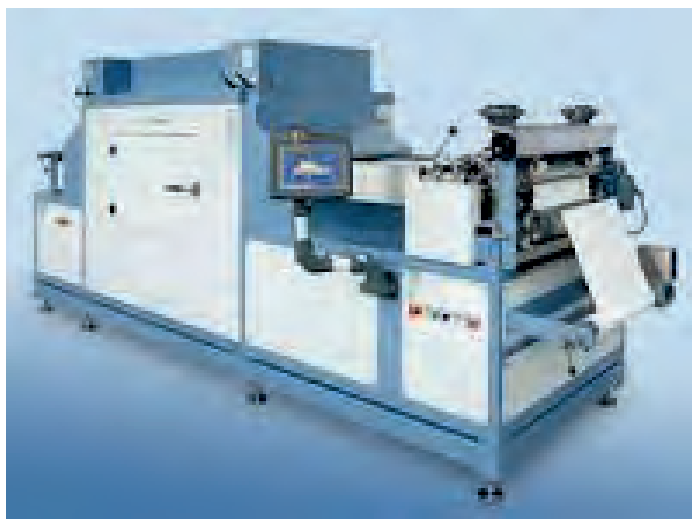
شکل ۳۰-۲ دستگاه حرارت خشک جهت تثبیت بیندراهای مرکب پیگمنت
