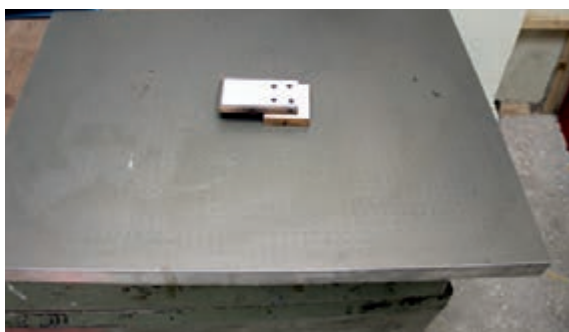
شکل ۲۸-۵ فیکسچرهایی که با چسب به میز دستگاه چسبانده می شوند
