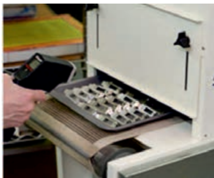
شکل ۳-۶۷- سنجش میزان حرارت خشک کن شکل
