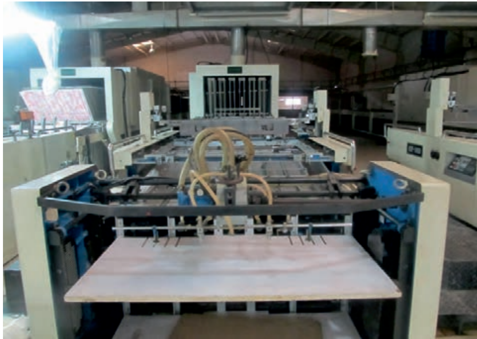
شکل ۲-۲۲ ماشین تمام اتوماتیک اسکرین با سرعت بالا
