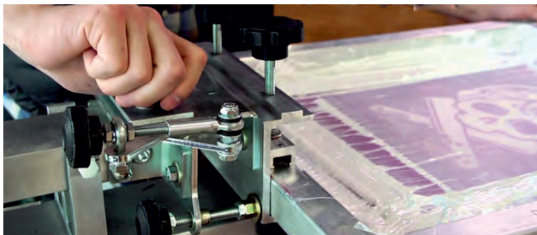
(شکل ۴-۴) گونیا کردن طولی و عرضی شابلون
