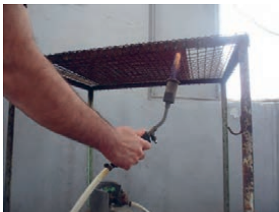
شکل ۴۷-۴- حرارت دادن کلیشه
