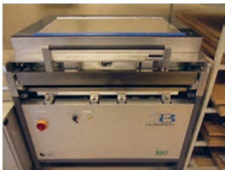
شکل ۱۷-۲ دستگاه قید کپی با نوردهی از پایین
