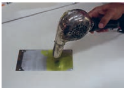
شکل ۴-۲۲- حرارت دادن کلیشه
