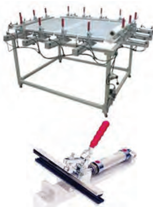
شکل ۵-۲۵- توری کش پنوماتیکی و گیره توری کشی به همراه مانیفولد
