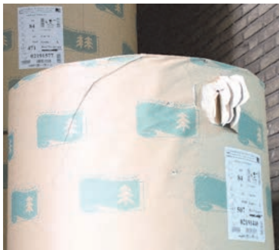
شکل ۶- خراش و پارگی روی بدنه رول
