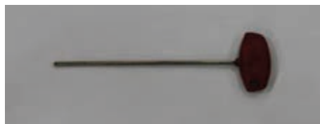
شکل ۵۱- آچار مخصوص باز کردن پلیت
