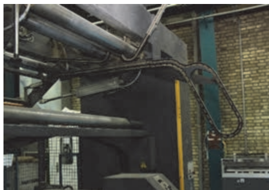
شکل ۲۶- سیستم کاغذ کشی زنجیری
