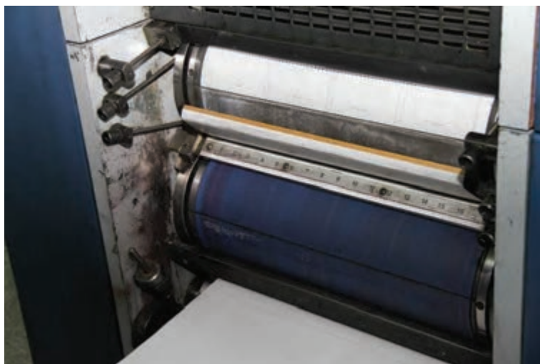
شکل ۵۵ - خارج کردن لبه ته کار پلیت از شیار سیلندر
