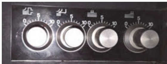
شکل ۱۹- شیرهای تنظیم باد
