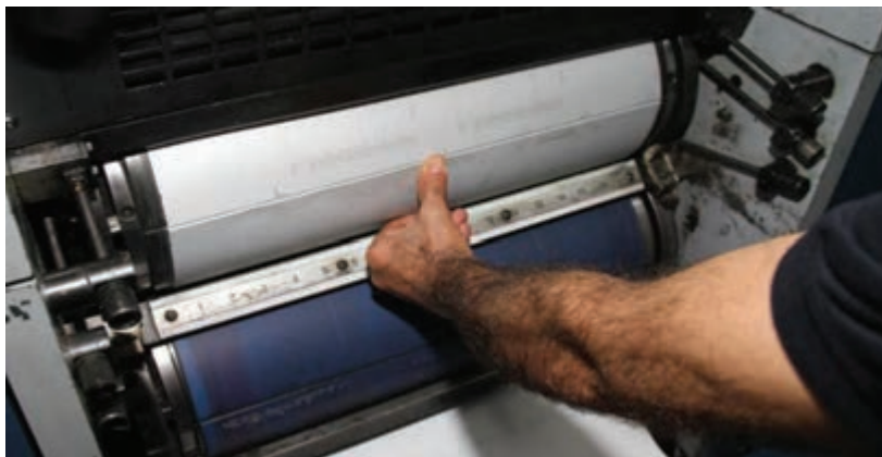
شکل ۷۱- قرارگیری ته کار پلیت در شیار سیلندر
